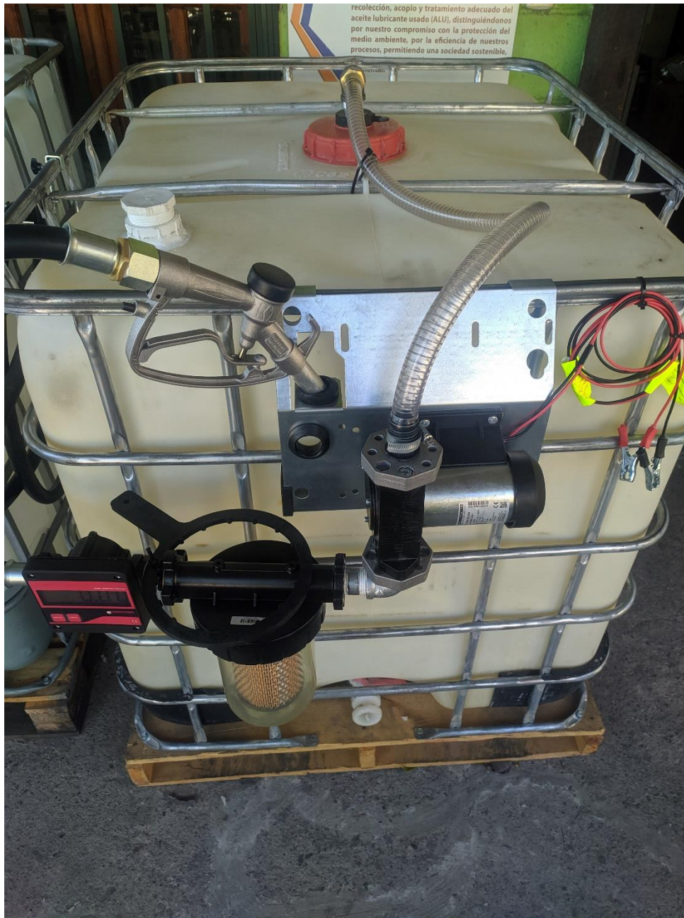
Ilustración 14-Sistema para trasiego de combustible
