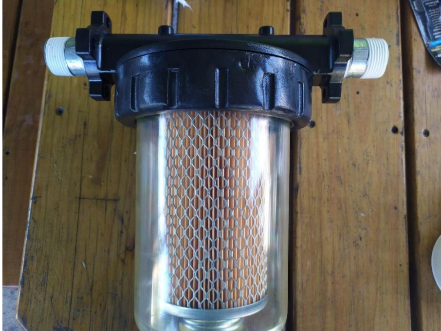
Ilustración 10-Colocación de niple HG en filtro
