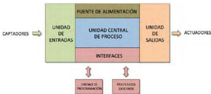
Ilustración 12. Arquitectura básica de un PLC
