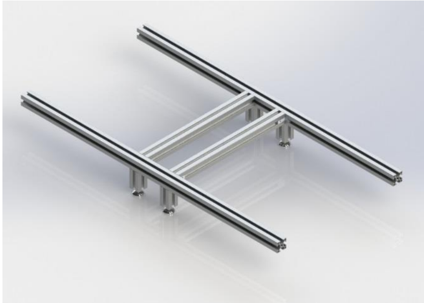
Anexo 3. Sub-ensamble parrilla para bomba.
