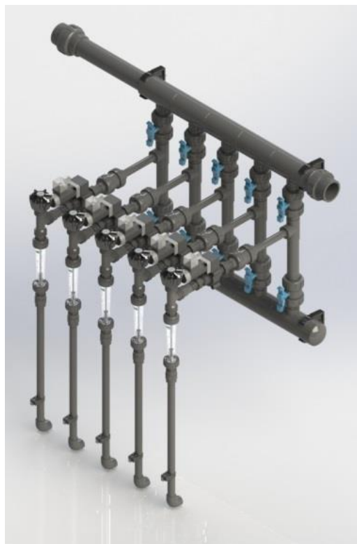
Anexo 6. Sub-ensamble tren de Venturi c/FIP.
