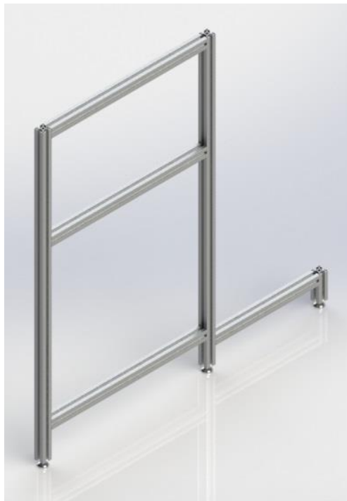
Anexo 2. Sub-ensamble lateral de perfiles.
