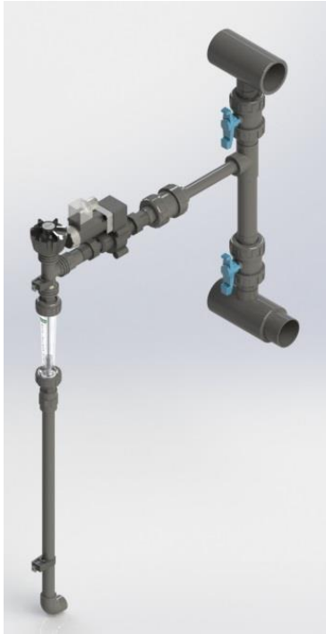
Anexo 5. Sub-ensamble dosificador 750LPH.
