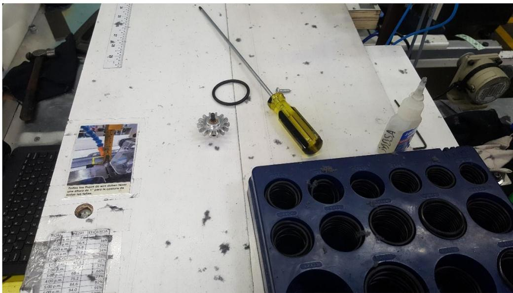
**Ilustración 32 - Instalación de O-Rings para las ruedas del alineador**
