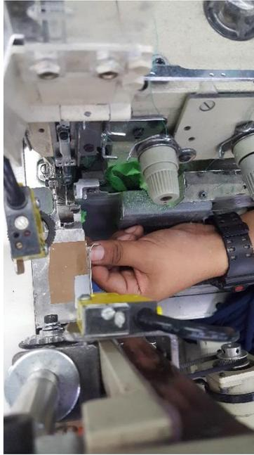
**Ilustración 27 - Revisión de alineación de la guía de trabajo**
