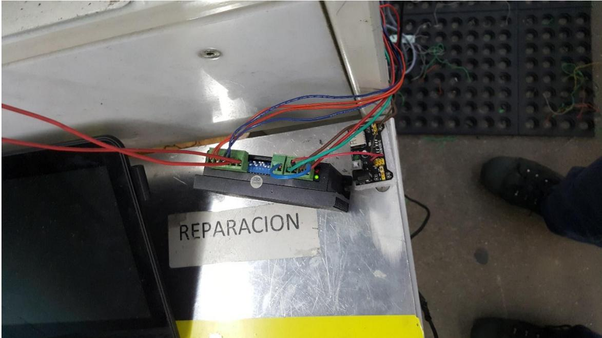
**Ilustración 14 – Controlador del motor durante las pruebas antes de la instalación del alineador.**
