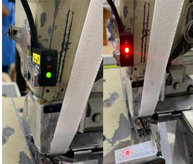
**Ilustración 12-Sensor Fotoeléctrico**
