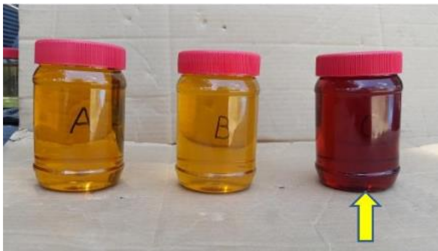
Ilustración 15- color de muestra anormal en elevador de 667 KVA en el año 2018
