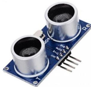
**Ilustración 23: Sensor ultrasónico HC-SR04**
