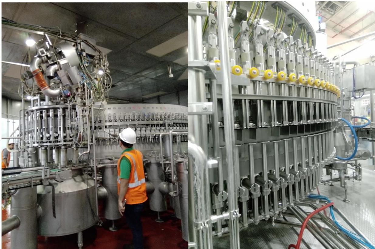
**Ilustración 29. Revisión de válvulas de la llenadora**
