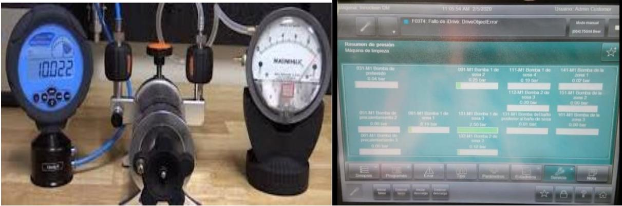
**Ilustración 23. Calibración de presostatos**
