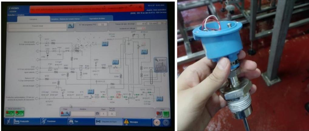
**Ilustración 25. Calibración de sensores de nivel**
