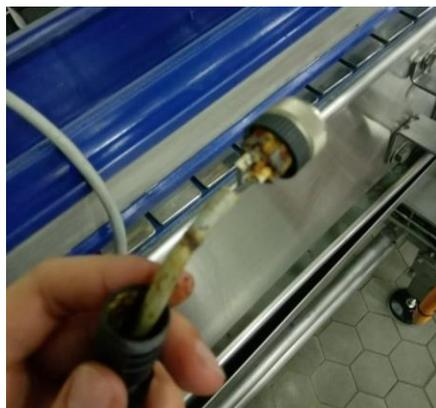
**Ilustración 27. Cable con mucha corrosión**
