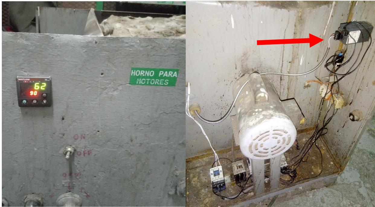
**Ilustración 36. Instalación de controlador de temperatura**
