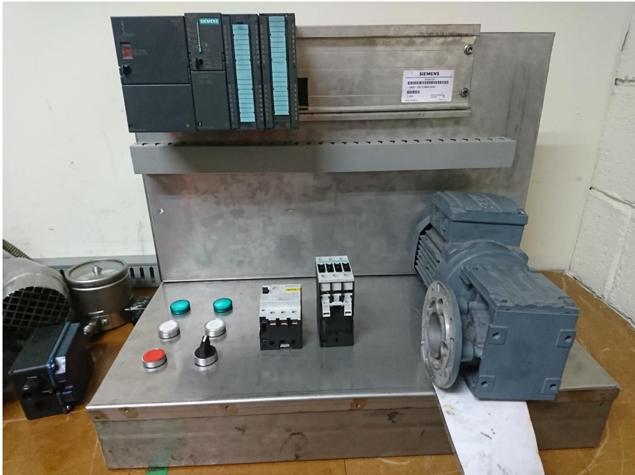
Ilustración 30. Estación de PLC - Entrenador Fuente: (Propia, 2018)
