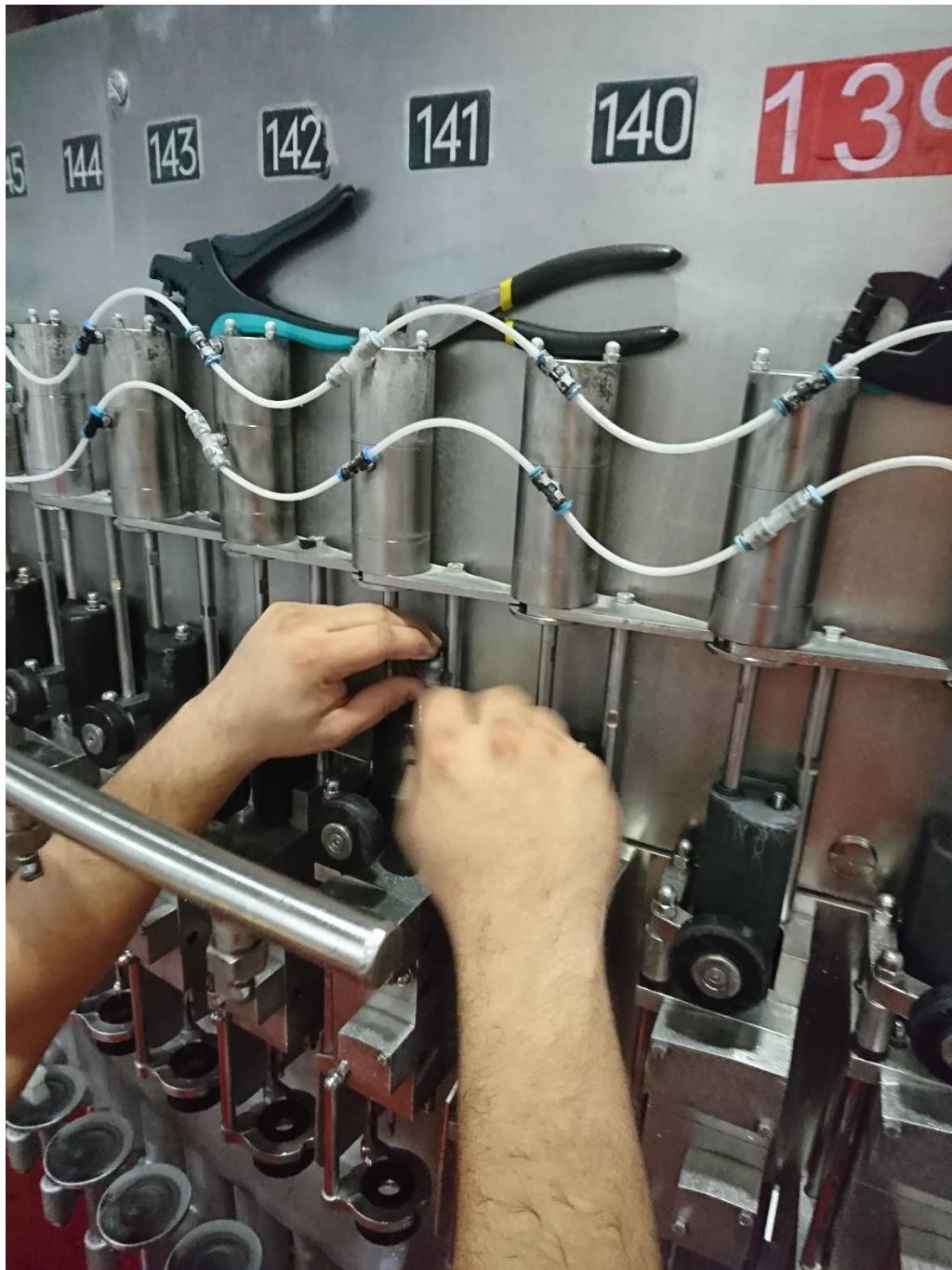
Ilustración 29. Mantenimiento preventivo de las conexiones de las sondas - Llenadora - Línea de producción #1
