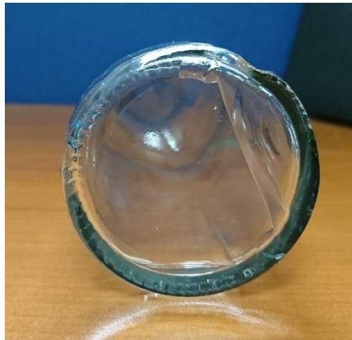
Ilustración 15. Botella patrón con defecto de vidrio faltante en parte inferior.
