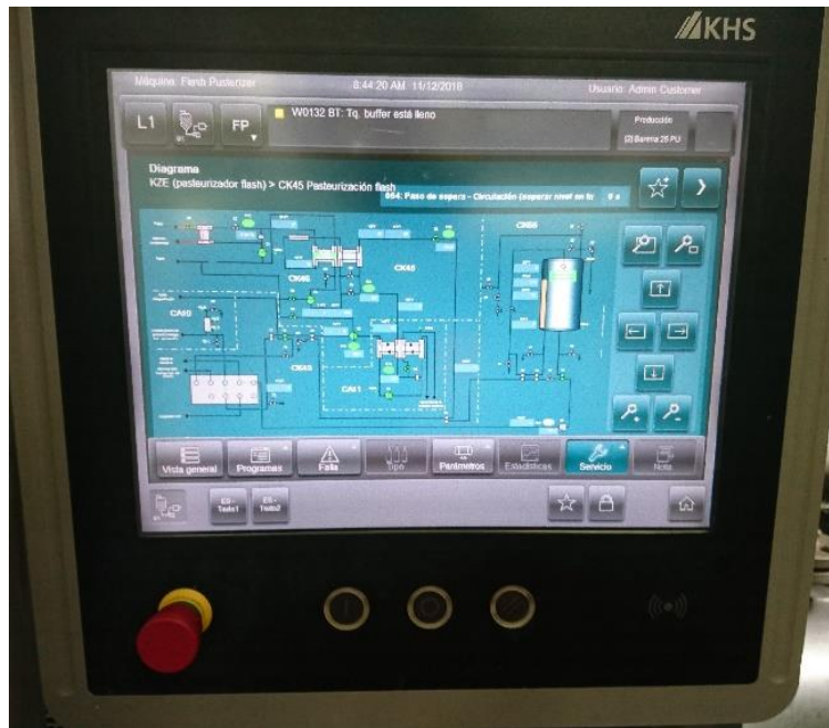
Ilustración 12. Diagrama de tubería del pasteurizador flash de la Línea 1 de producción.
