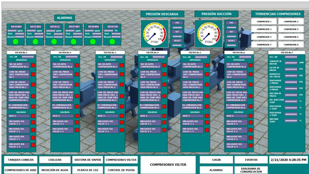
Ilustración 14. SCADA de supervisión de compresores vilter.
