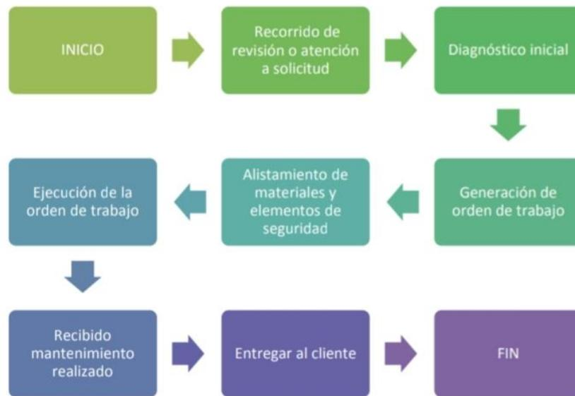
**Ilustración 19. Esquema Mantenimiento Correctivo**
