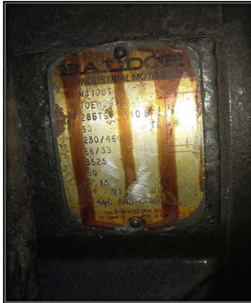
**Anexo 15-Datos de placa para parametrización de motor de 30 HP**
