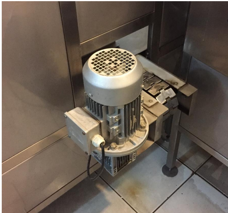
Ilustración 1: Motor trifásico con reductor de velocidad.
