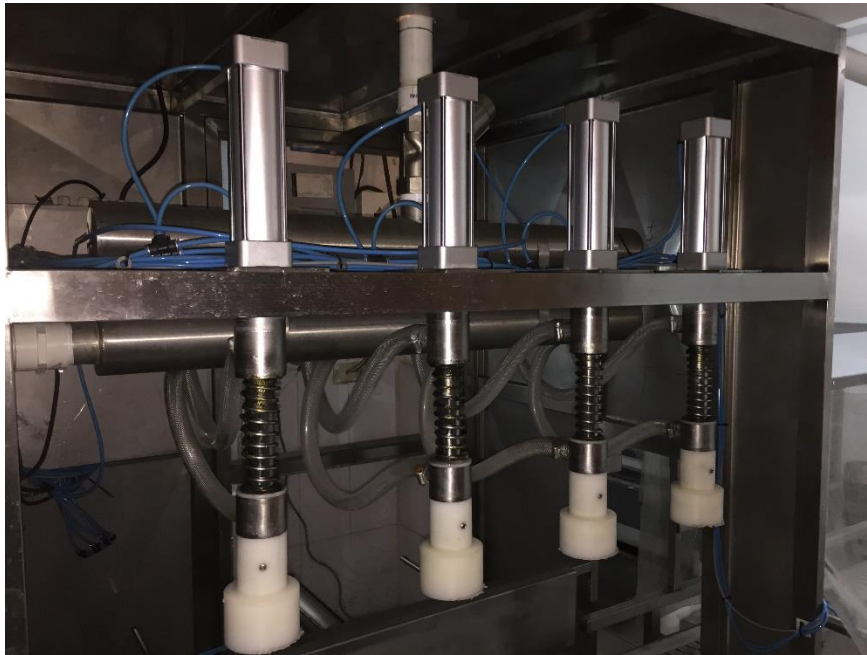
Ilustración 4: Pistones neumáticos utilizados en maquina embotelladora de agua.
