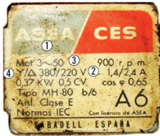
Ilustración 6. Placa característica de un motor
