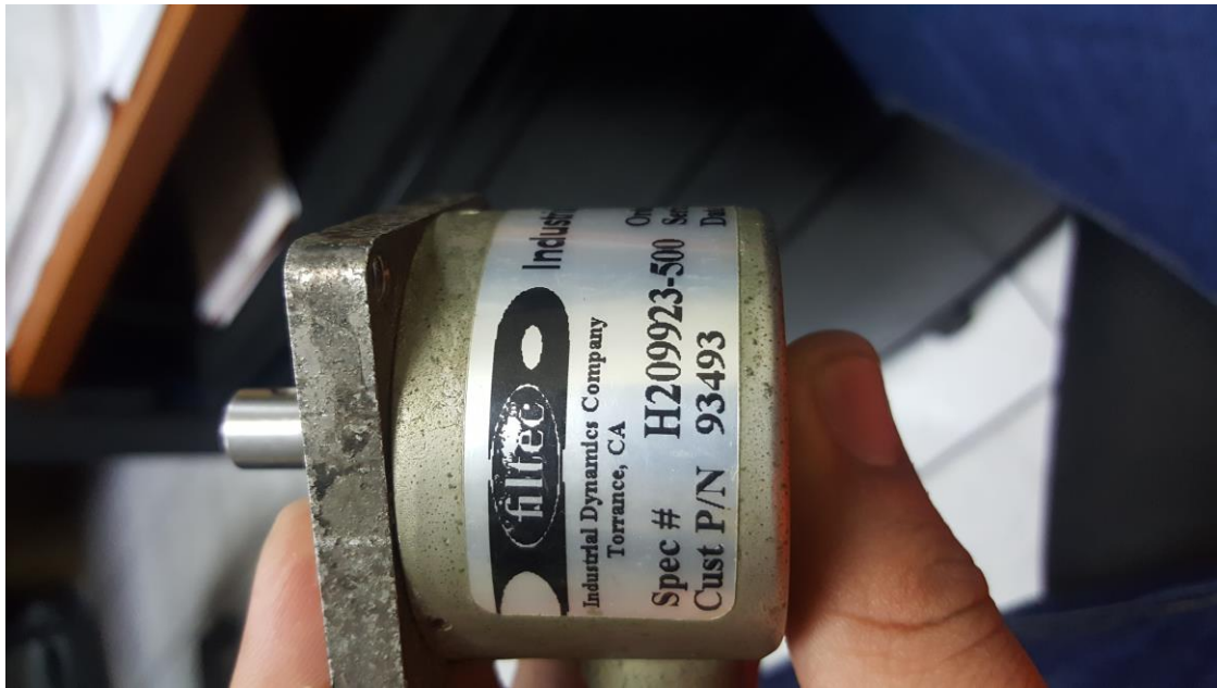
Ilustración 25. Encoder del inspector de botella llena marca Sick
