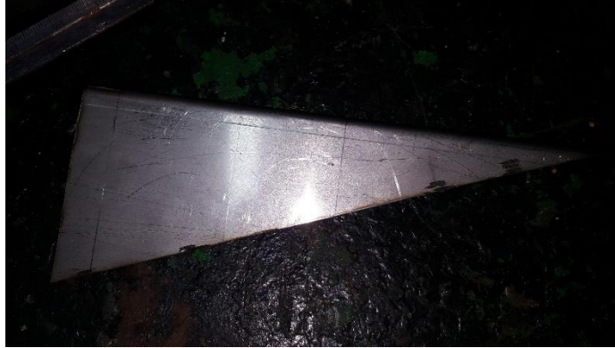
Ilustración 7. Corte de pieza para estructura de entrenador PLC
