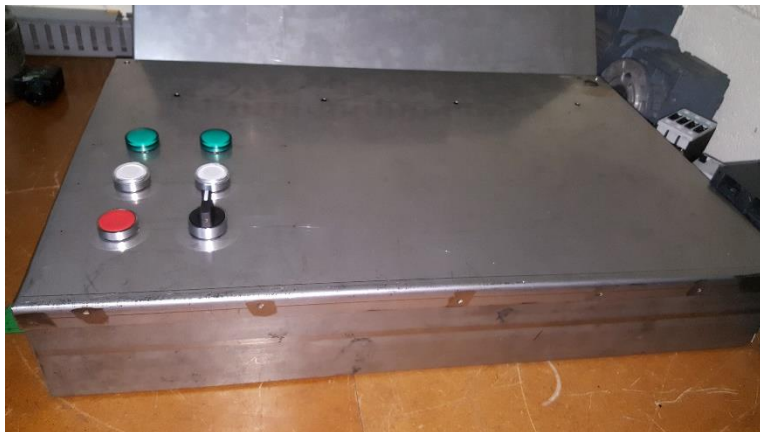
Ilustración 8. Panel inferior de estación de entrenamiento PLC (botoneras, luces piloto y selector)
