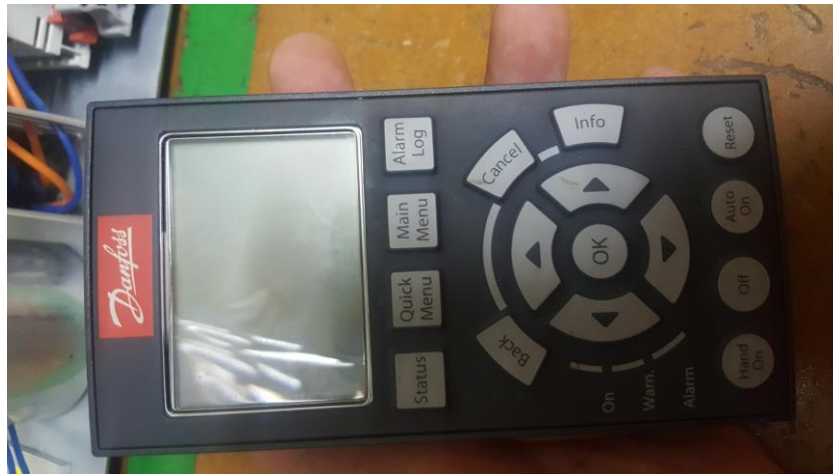
Ilustración 15. Pantalla controladora de variador Danfoss
