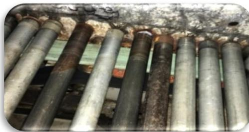
**Ilustración 33 Sistema de Rodillos Mesa Compactación**
