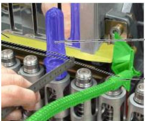
**Ilustración 39 Calibración Rampa Fija**
