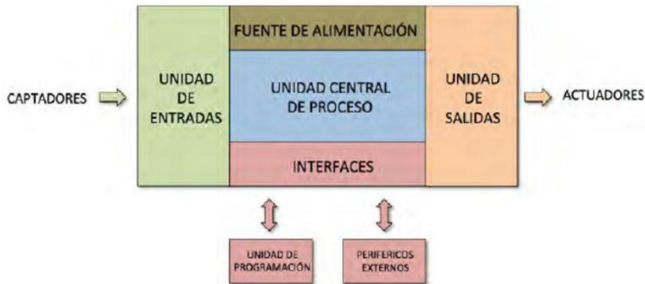
Ilustración 7. Esquema funcional de un sistema automatizado
