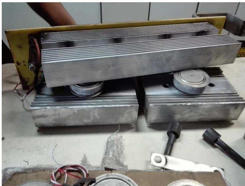
**Ilustración 15: Cambio de Diodos SCR**
