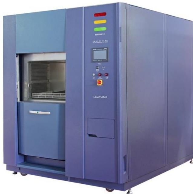
**Ilustración 8. Cámara de Prueba de Choque Termal**
