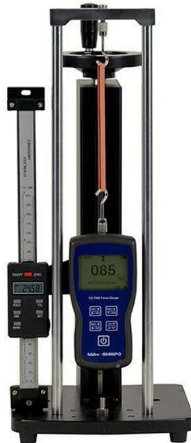
**Ilustración 9. Banco de Prueba de Compresión, Tensión, Tracción, Compresión y Fuerza**
