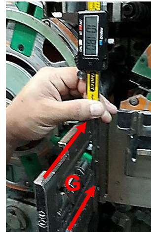
Paso #7: Verificar distancia G entre superficie superior del libro y el tope inferior del lado de adentro sea de 101.8mm +/- 0.1mm
