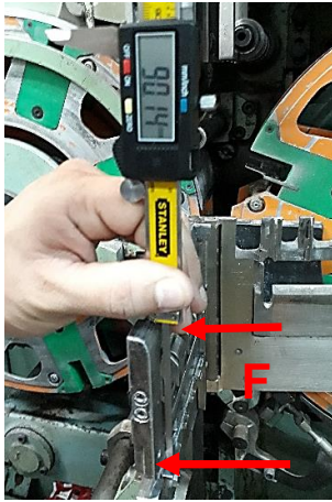
Paso #6: Verificar distancia F entre superficie superior del libro y el tope inferior del lado de afuera sea de 90.14mm +/- 0.1mm
