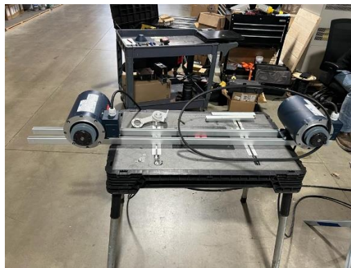
Ilustración 59. Montaje de motores y poleas.
