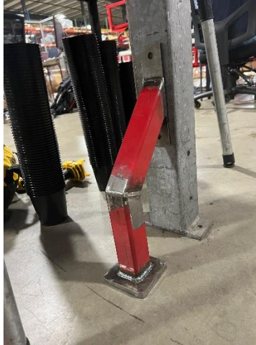
Ilustración 102. Soporte de guarda fabricado.
