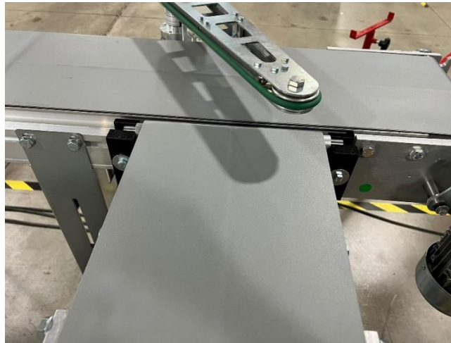
Ilustración 106. Montaje de Soporte de bandas.
