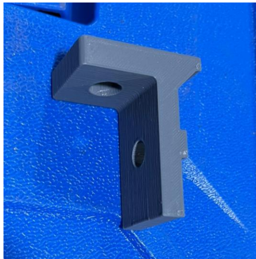
Ilustración 112. Soporte para Sensor de luz impreso.
