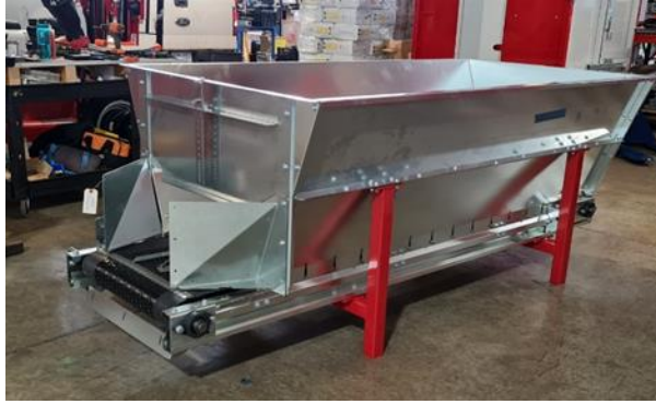
Ilustración 21. Hopper de 2YD completamente ensamblado.
