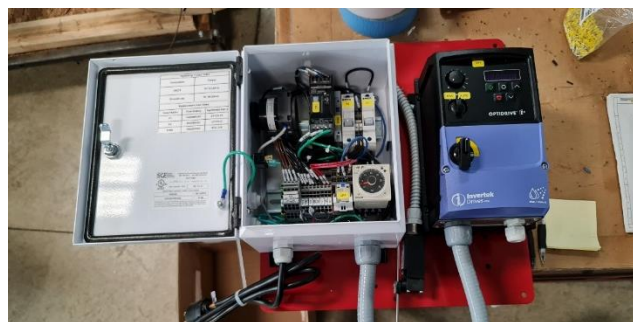
Ilustración 49. Ensamble completo de Caja Control.
