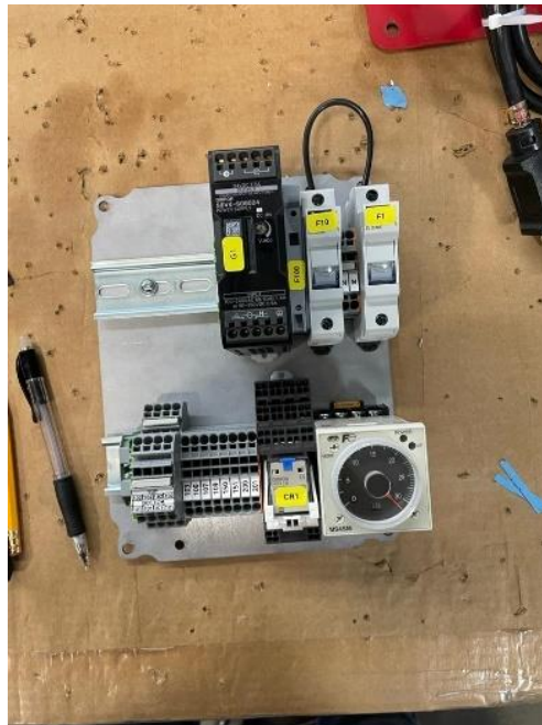
Ilustración 41. Montaje Panel de Control.
