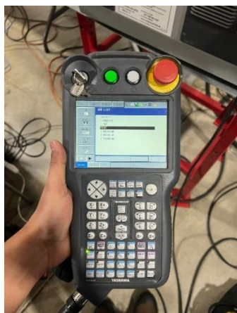
Ilustración 88. Controlador del robot.
