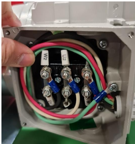
Ilustración 22. Conexión de 6 pines WYE-DELTA.
