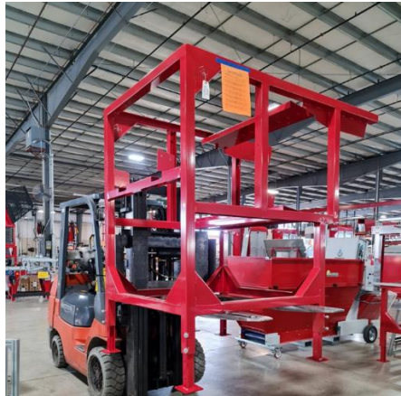
Ilustración 16. Estructura Metálica de la PDX1.
