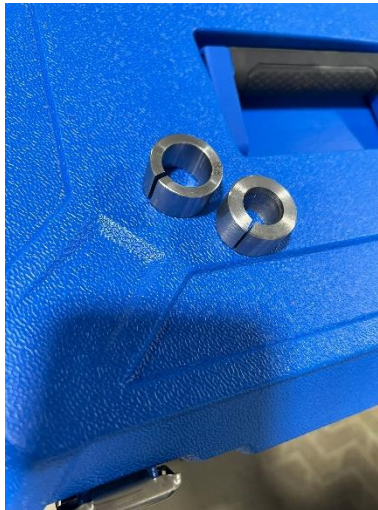
Ilustración 94. Mecanizado de acople para motor.
