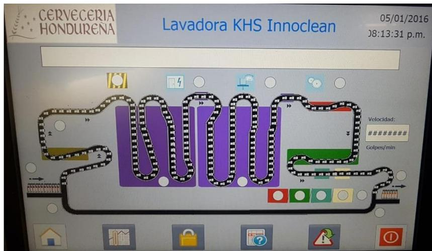
**Ilustración 13. Diseño nuevo pantalla lavadora KHS**
