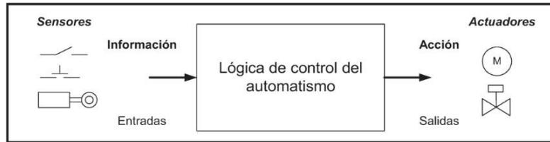
**Ilustración 5. Componentes de un automatismo**
