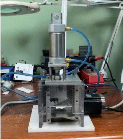
Ilustración **18** el cual desarrollaba el dispensado y el corte del elástico. En la parte derecha de la ilustración se observa el motor que tenía sujeto unos rodos para poder hacer el proceso de dispensado, procediendo a realizar el corte mediante una cuchilla que dependiendo de la cantidad de presión de aire que entra por la manguera es la fuerza con la que se realiza el corte.
