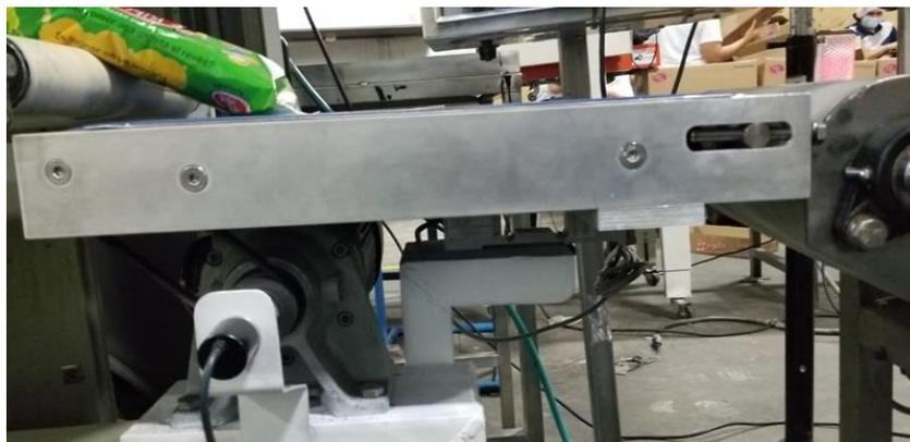
**Ilustración 40- Banda Transportadora**
