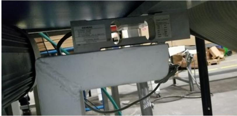
**Ilustración 41- Celda de Carga Instalada**
