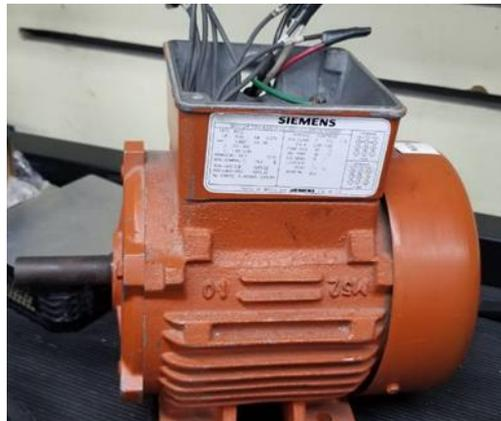
**Ilustración 24- Motor trifásico inductivo**
