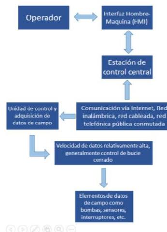
**Ilustración 5- Funcionamiento del sistema SCADA**
