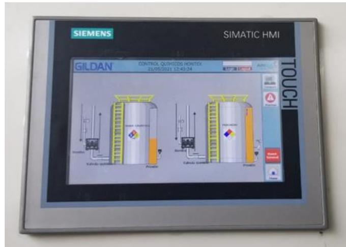
**Ilustración 28- Supervisión de sensores de presión**
