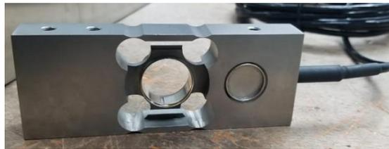
**Ilustración 36- Celda de Carga**
