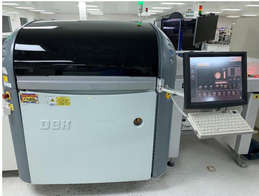
Ilustración 8- Impresora de plantillas
