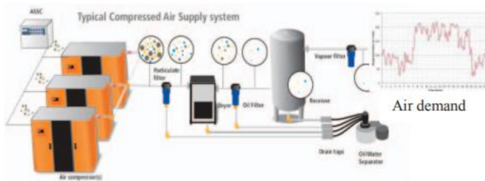
Ilustración 9 Esquema del sistema del aire comprimido
