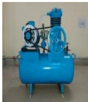
Ilustración 10 Compresor de aire
