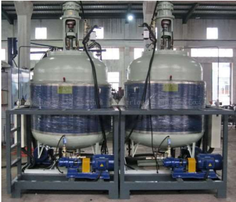
Ilustración 4. Tanques de almacenamiento de Polioli e Iso
