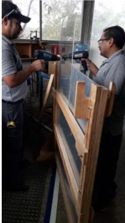
Ilustración 23. Proceso de doblado de Acrílico
