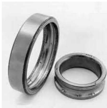
Ilustración 22. Daños anillo de rodamiento
