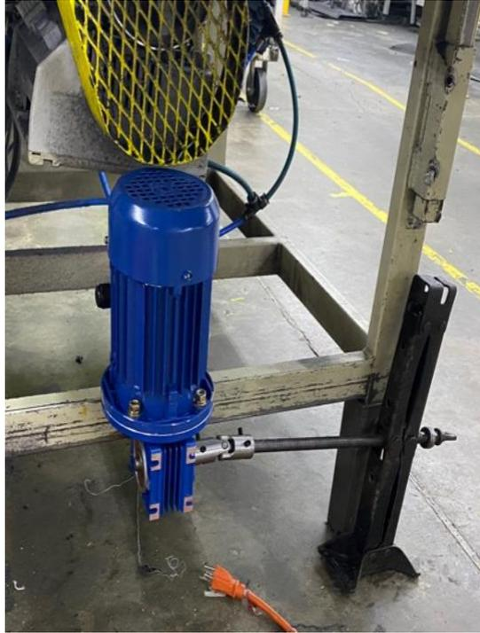
**Ilustración 8 Motor Acoplado a Eje**
