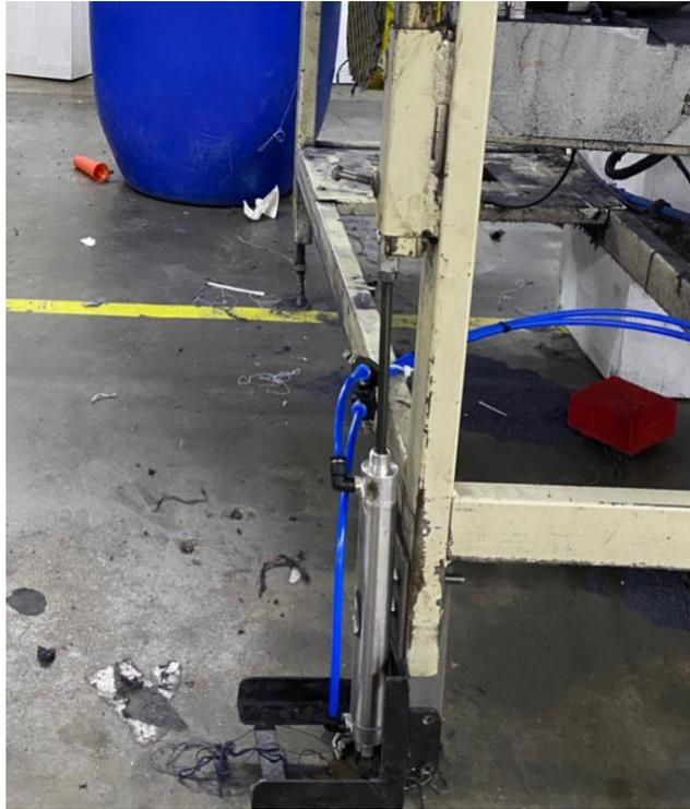
**Ilustración 11 Pistón Utilizado Montado**
