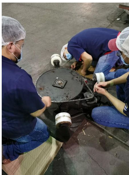
Ilustración 43: Sección Interna de Tarima Rotatoria del Envolvedor Línea 80
