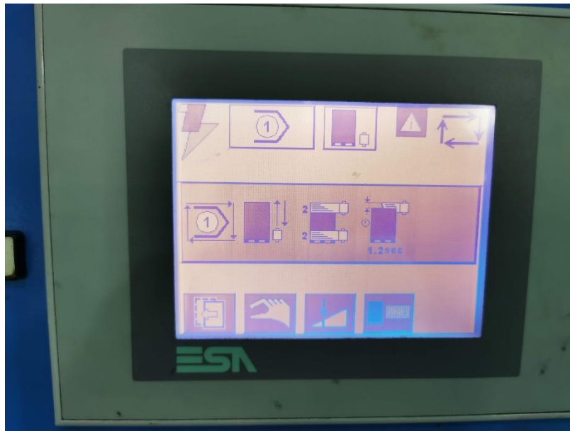
Ilustración 34: HMI Utilizada Para Controlar Parámetros del Robopac
