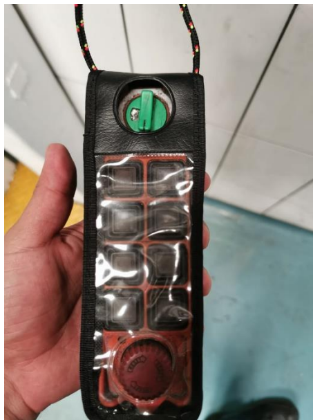
Ilustración 19: Control que Recibe Señales de Radio Frecuencia
