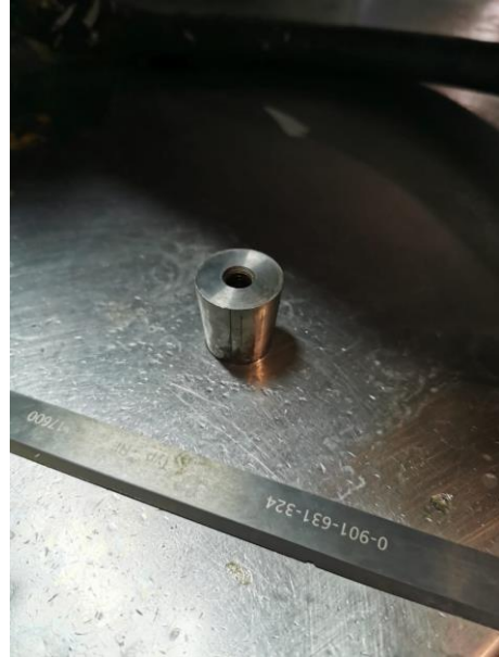
Ilustración 35: Piezas que Cedieron y Cono de Etiquetadora
