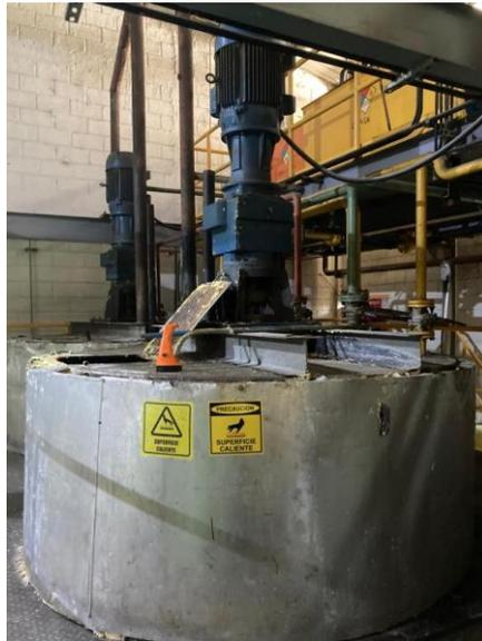
**Ilustración 9. Tanque de empaste de jabón**
