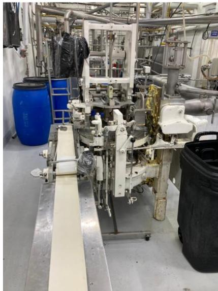
**Ilustración 7. Máquina de empaquetado margarina Olepsa**
