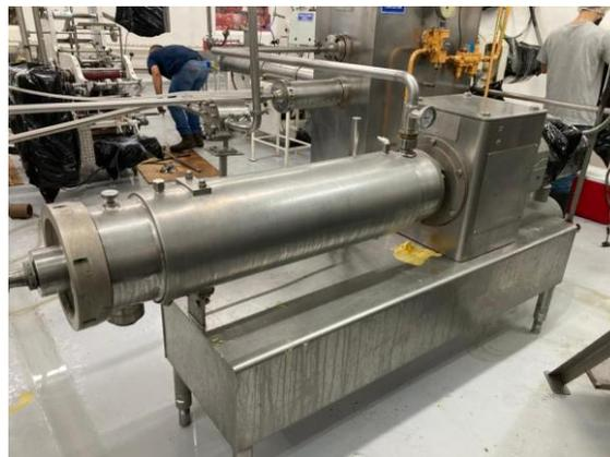
**Ilustración 5. Rotor de pin planta margarina Olepsa**
