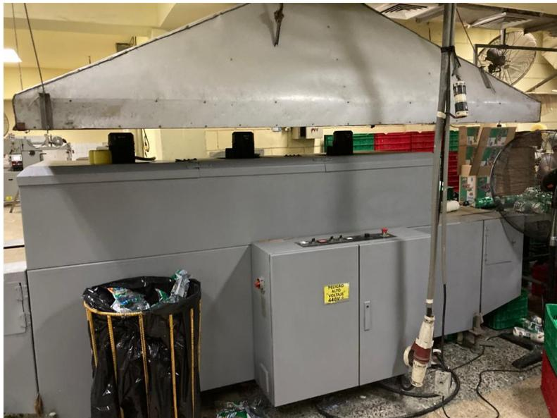
**Ilustración 20. Túnel termo encogible**
