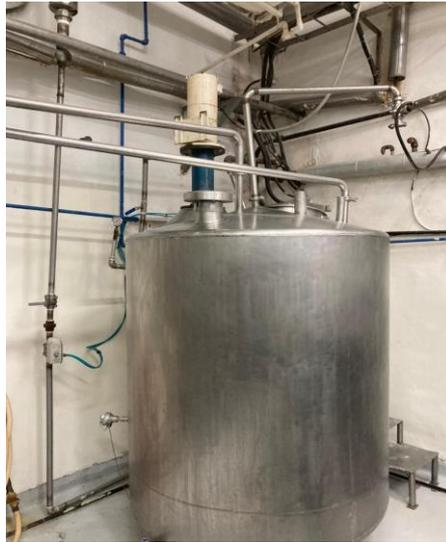
**Ilustración 3. Tanque mezcla planta margarina Olepsa**
