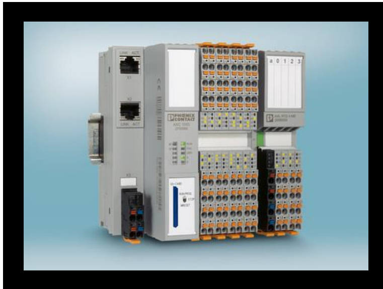
Ilustración 8. PLC AXC1050 de Phoenix Contact acoplado a módulos de I/O digital y un módulo de entrada análoga.
