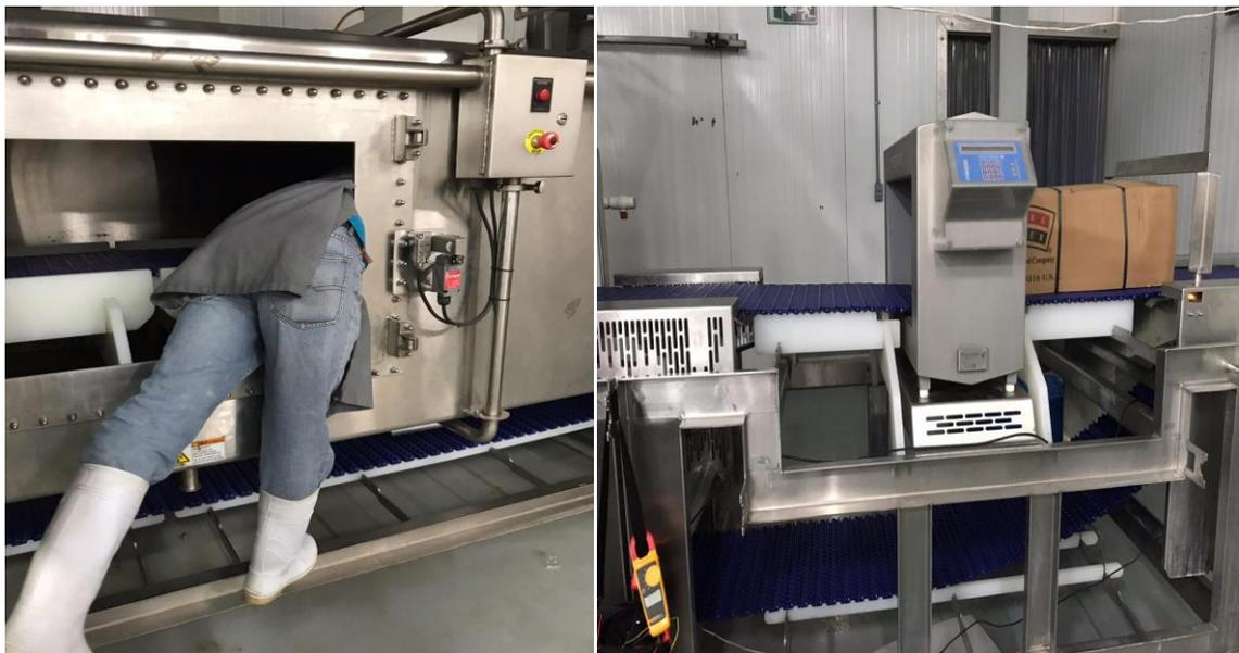
**Ilustración 21 - Reemplazo de la banda nueva**
