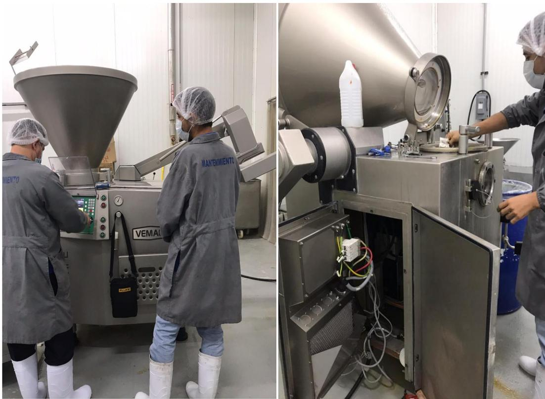
**Ilustración 22 - Limpieza de embutidora**
