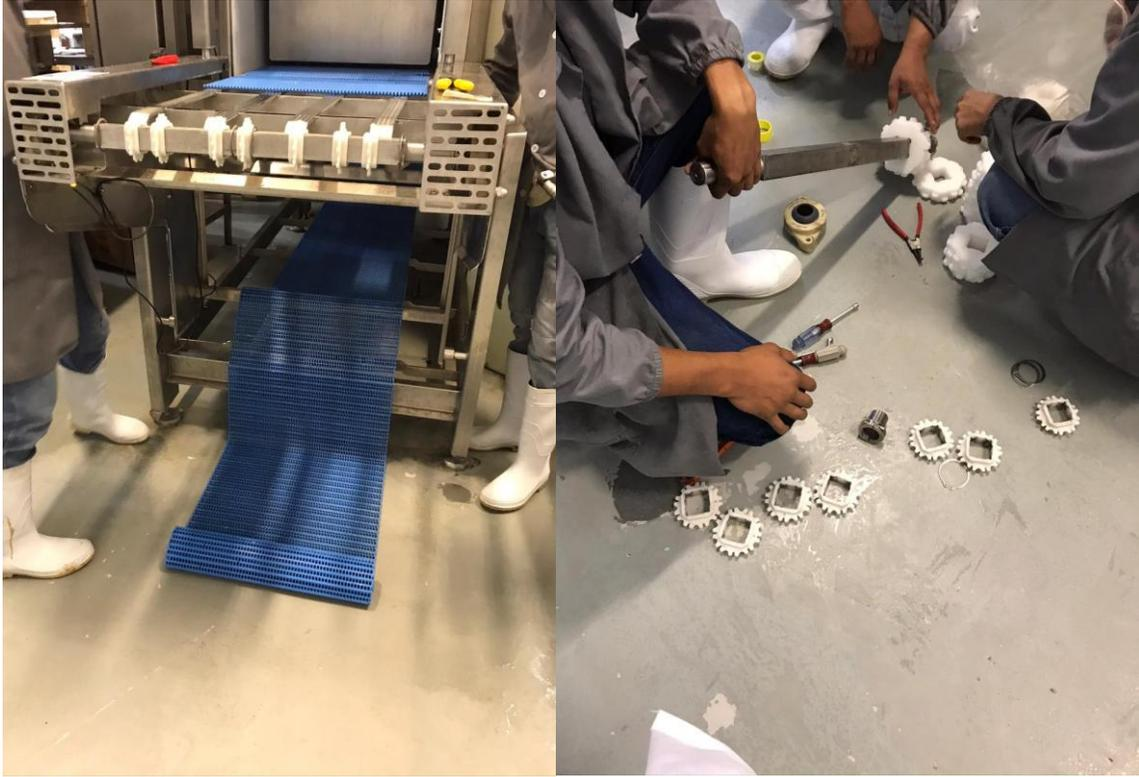
**Ilustración 19 - Proceso de cambio de banda**
