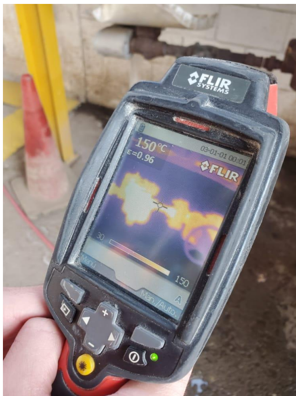
Ilustración 9- Revisión de temperatura de trampas de vapor
