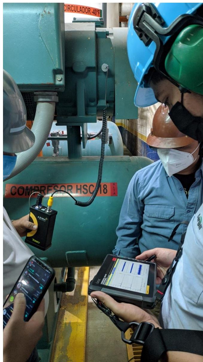
Ilustración 11. Análisis de vibraciones mecánicas en compresor
