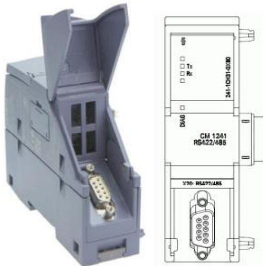
*Ilustración 7 Módulo de Comunicación CM 1241 (RS422/485)*
