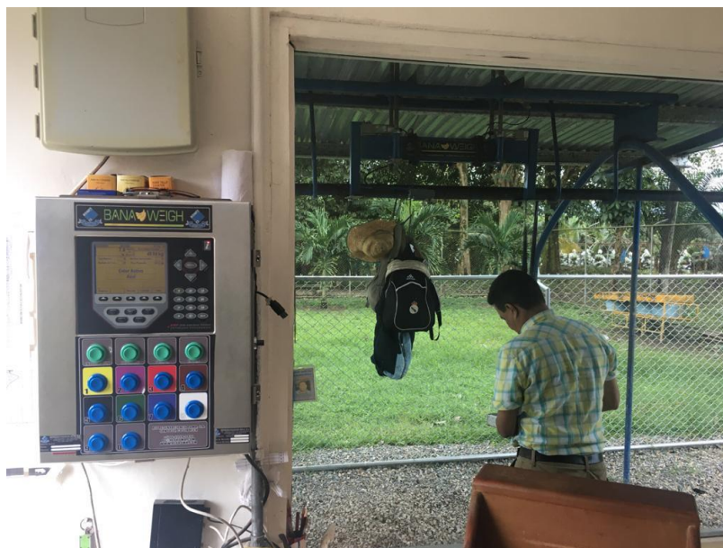
Ilustración 19. Calibración de bascula “Banaweigh”
