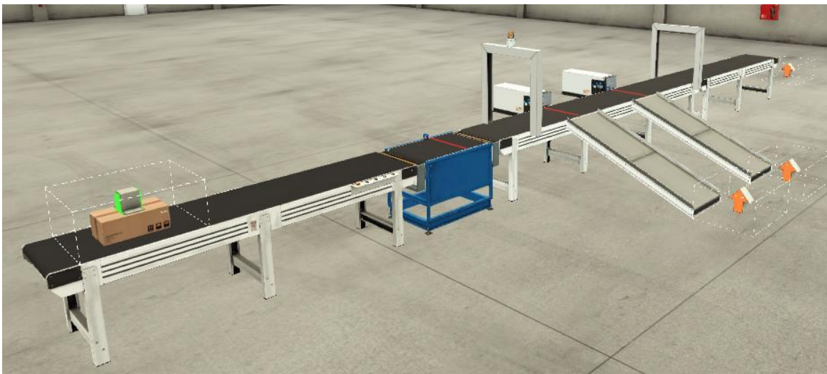
Ilustración 29. Proceso de pesaje automatizado mediante pistones
