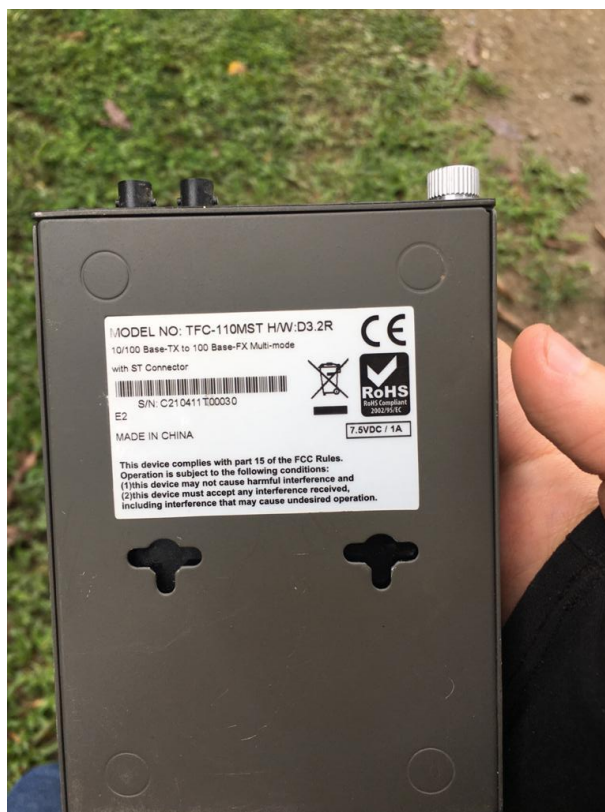
Ilustración 18. Convertidor de fibra óptica
