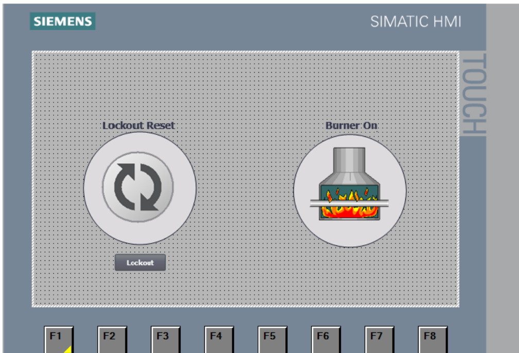
Ilustración 26: Selector Lockout Reset / Burner On
