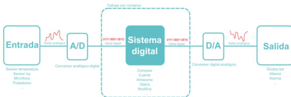
**Ilustración 2- Esquema de un sistema digital**
