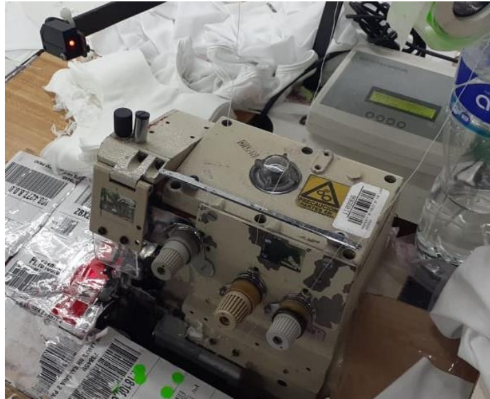
Anexo 6. Sensor de paro de paño montado en máquina de costura
