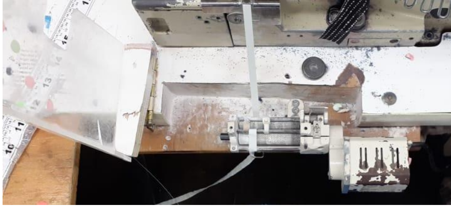
Anexo 9. Motor al cual se diseñó nuevo acrílico para protección de el
