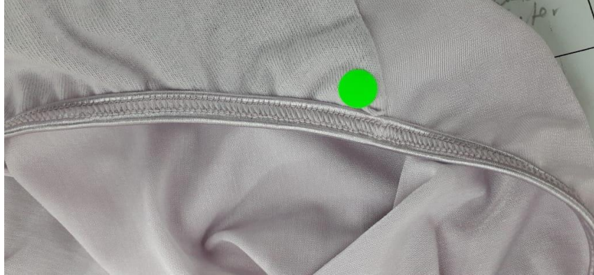
Anexo 5. Defecto de costura abierta en prenda
