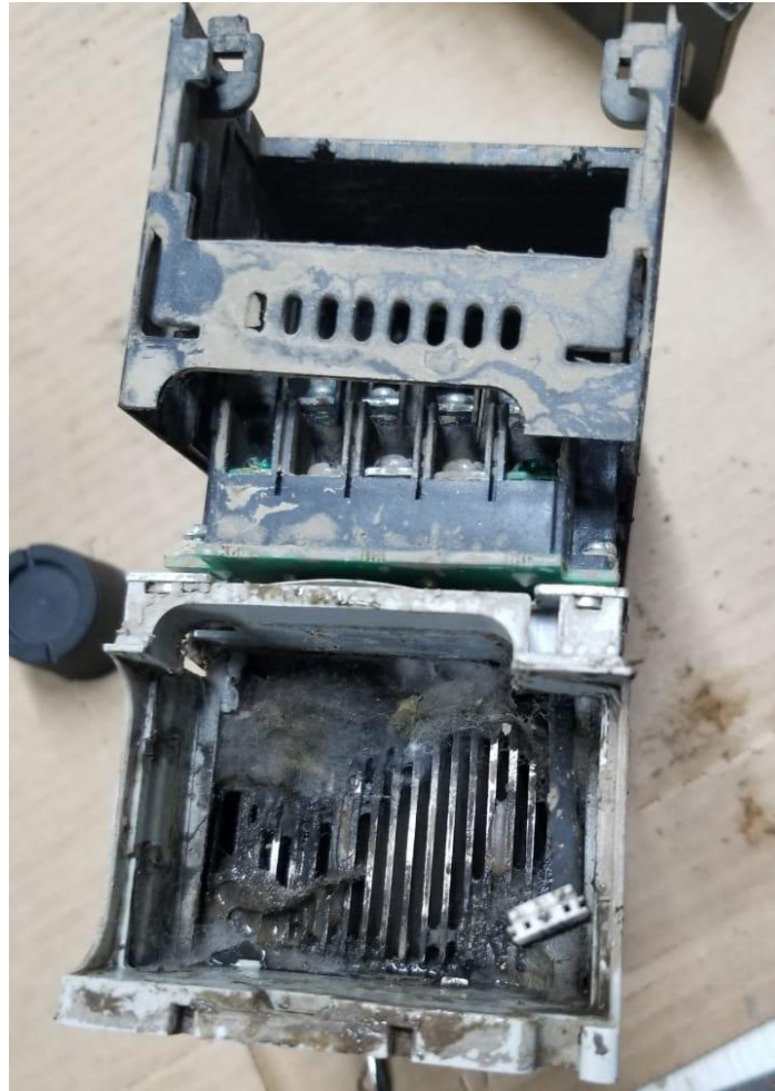
Ilustración 25: Variador con humedad y suciedad
