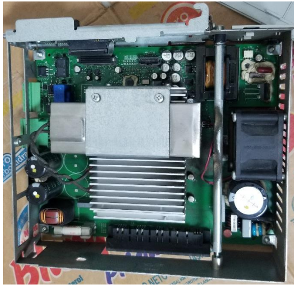
Ilustración 32: Drive desarmado para limpieza
