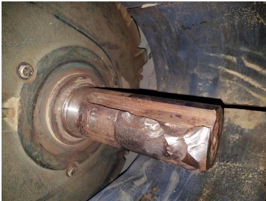
Ilustración 23 Rotor de trilla dañado.
