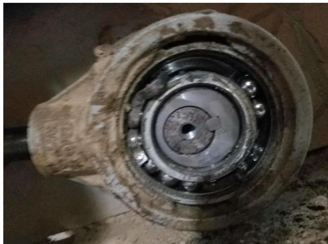
Ilustración 22 Eje Excéntrico dañado.
