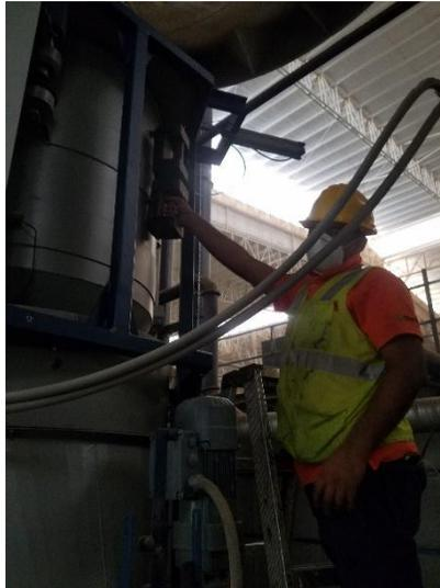
Ilustración 17 aplicación de pesos de prueba *smartflux*.
