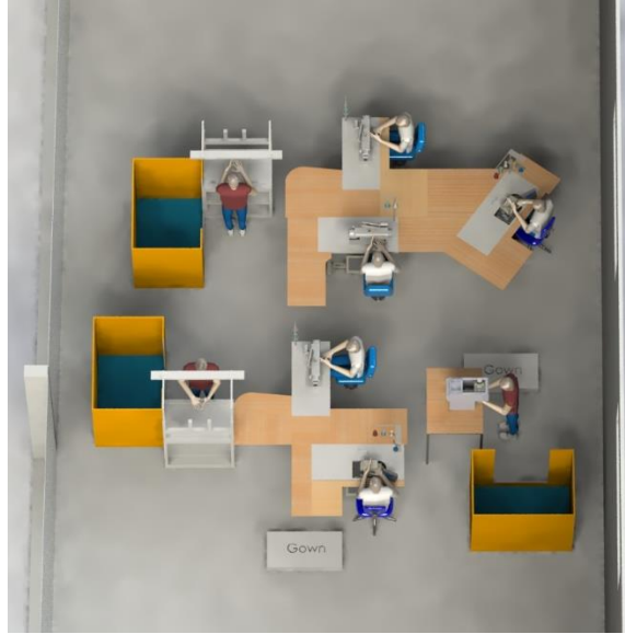
Ilustración 21. Prototipo diseñado para el área de fabricación de batas medicas en planta. Elaboración propia (2021).
