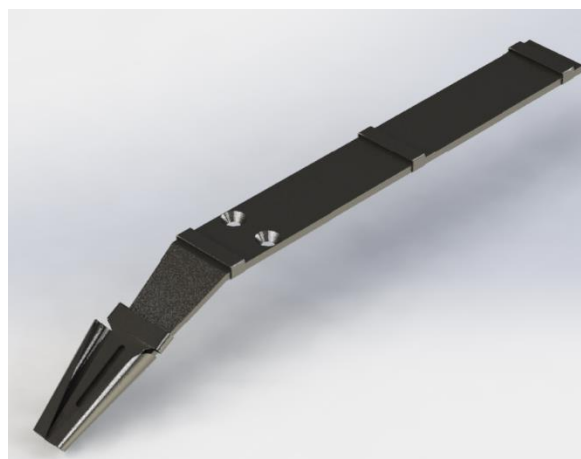
Ilustración 27. Diseño de ayudas para costurar el elástico a la cintura de pantalones. Elaboración propia (2021).
