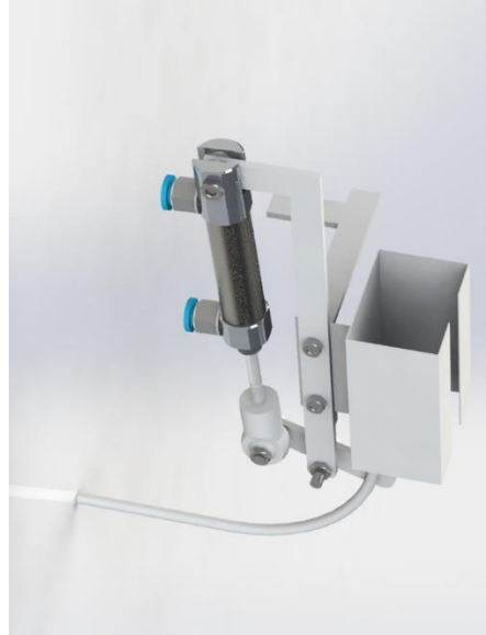
Ilustración 26. Dispensador de etiquetas diseñado. Elaboración propia (2021)
