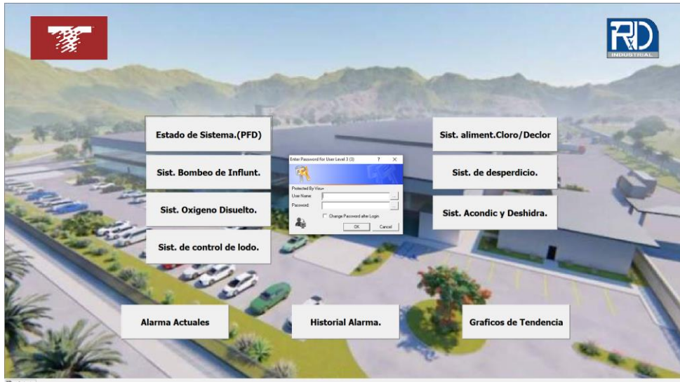
Ilustración 13 Menu principal con acceso de seguridad de la pantalla HMI TEGRA Fuente: Propia.
