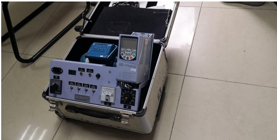
Ilustración 10 Variador de frecuencia utilizado en el PID Fuente: Propia.
