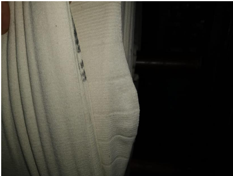
Ilustración 19. Defecto de lycra caída.
