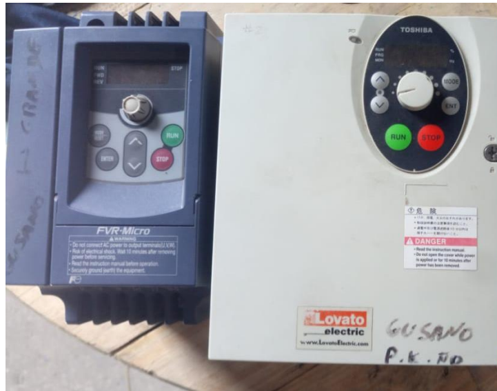
Ilustración 18. Variadores de velocidad
