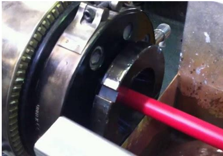
Ilustración 12. aplicación de aislamiento
