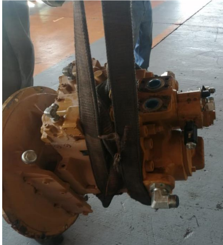
Ilustración 74: Desacople de bomba hidráulica de pistones
