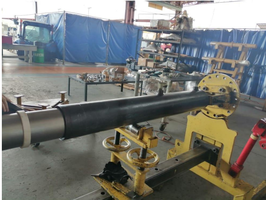
Ilustración 112: Desarmado de cilindro hidráulico de volqueta
