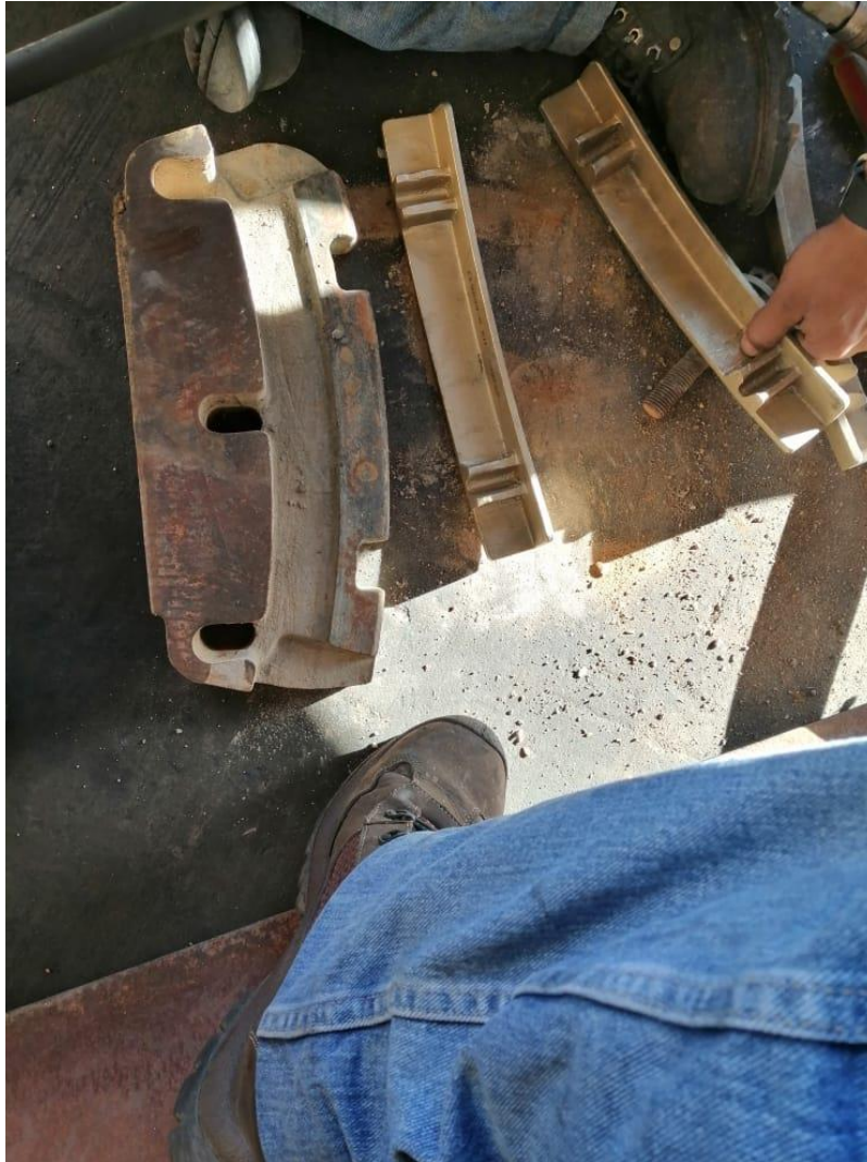
Ilustración 66: Placas de ajuste en mala condición por exceso de uso
