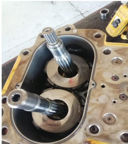
Ilustración 81: Superficie de inclinación de los tambores
