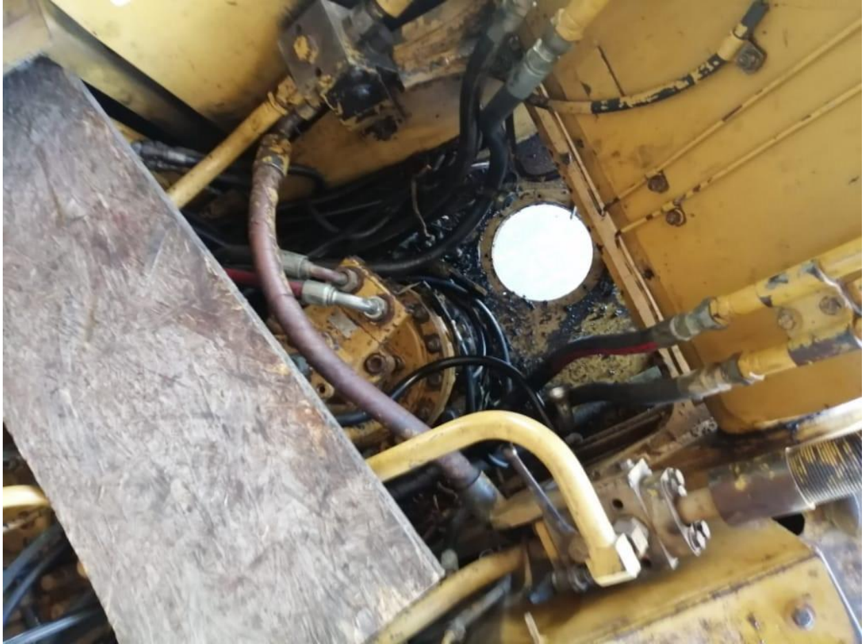
Ilustración 41: Desacople de junta giratoria central dentro del chasis de la excavadora
