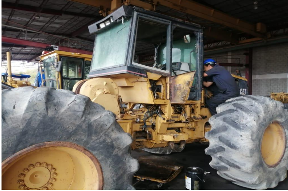
Ilustración 20: Desacople de cabina del Skidder 525
