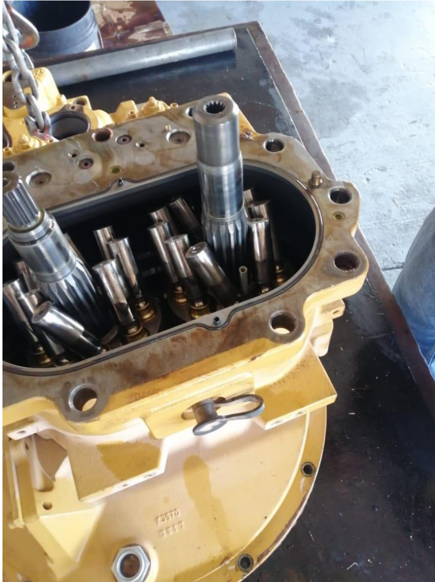
Ilustración 79: Tambores giratorios con pistones de presión
