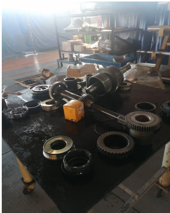
Ilustración 32: Ejes y embragues separados de la transmisión
