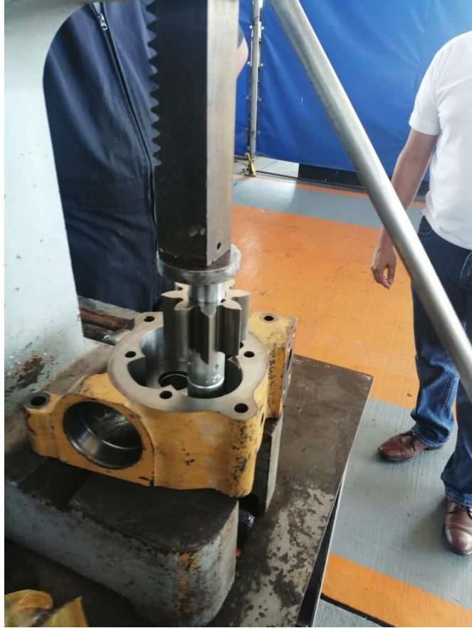
Ilustración 92: Cambio de bujes de aluminio de los ejes de engranes
