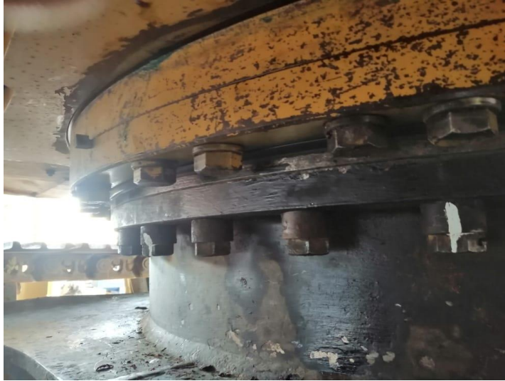
Ilustración 51: Todos los pernos acoplados con 660 libras de torque
