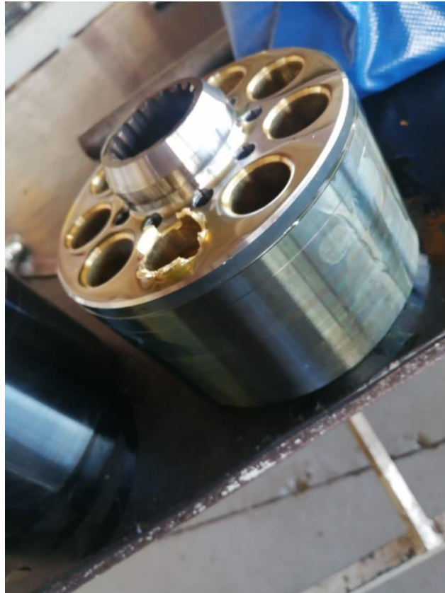
Ilustración 84: Fractura de cámara de pistón en tambor giratorio
