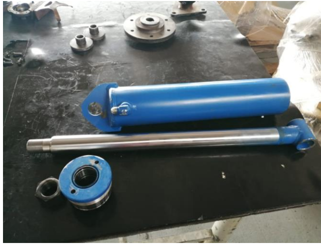
Ilustración 115: Desmontaje y reparación de cilindro hidráulico
