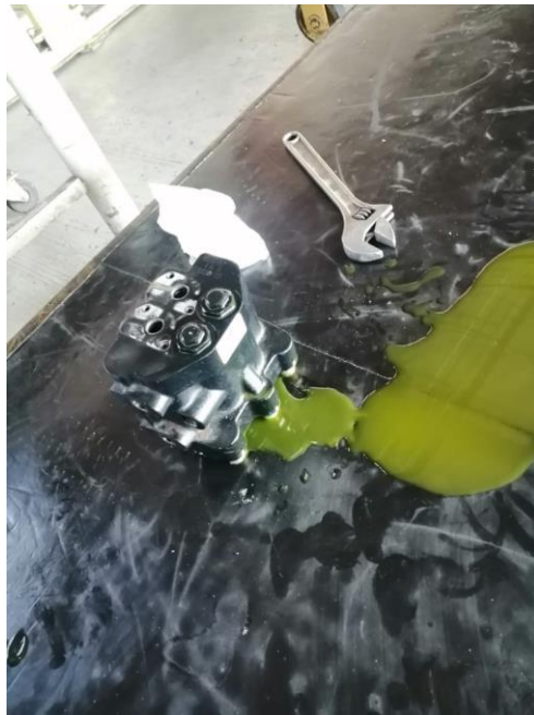
Ilustración 108: Vaciado de aceite hidráulico para limpieza
