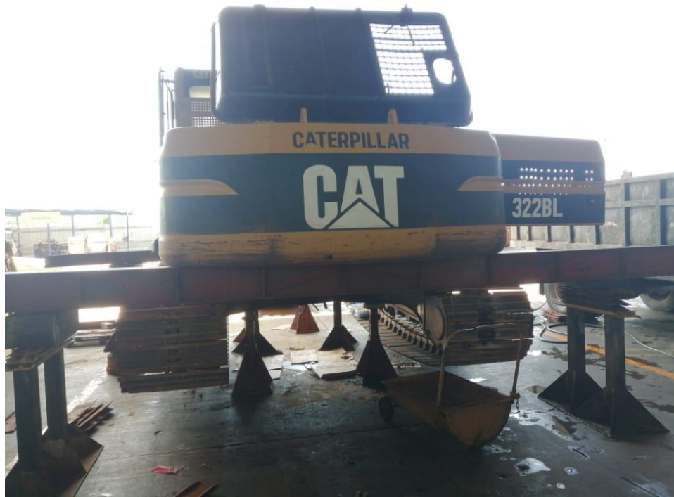
Ilustración 35: Excavadora embancada para desacople de orugas con resto del chasis
