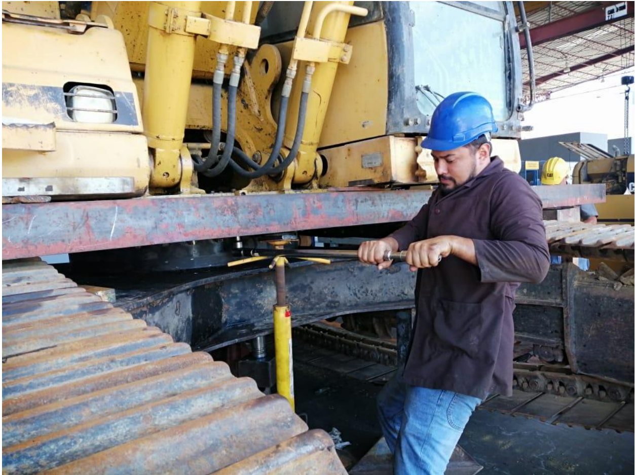
Ilustración 50: Torquímetro especial para 660 libras de torque a pernos de acople
