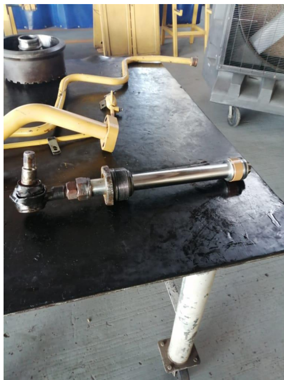
Ilustración 61: Desarmado de cilindro hidráulico dañado
