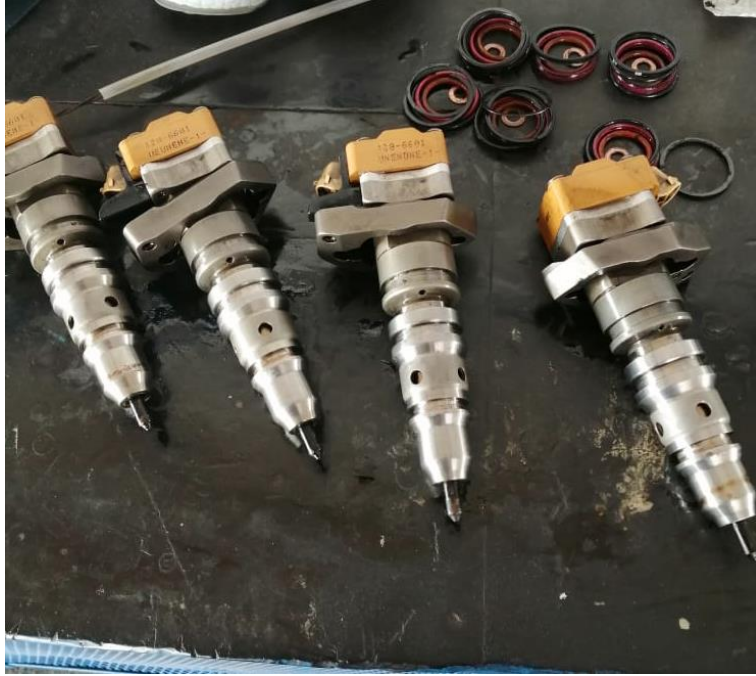
Ilustración 104: Cambio de sellos de inyectores
