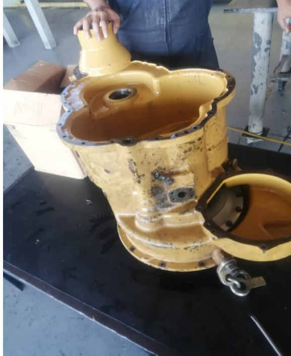
Ilustración 31: Proceso de desarmado de transmisión
