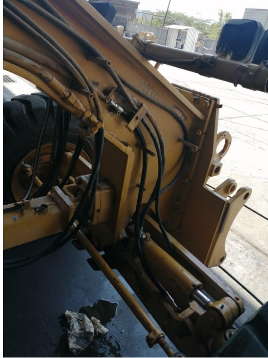
Ilustración 57: Desacople de guarda protectora de líneas hidráulicas
