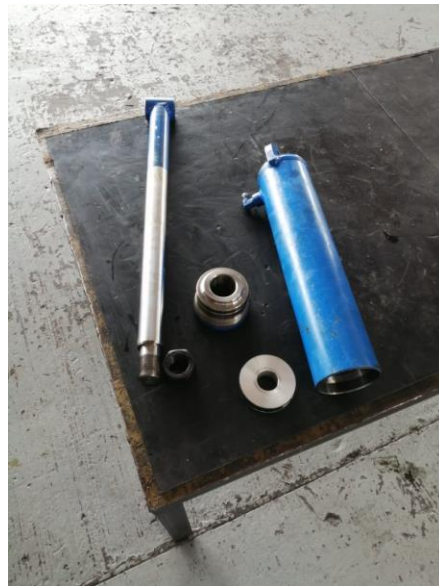
Ilustración 116: Desmontaje y reparación de cilindro hidráulico
