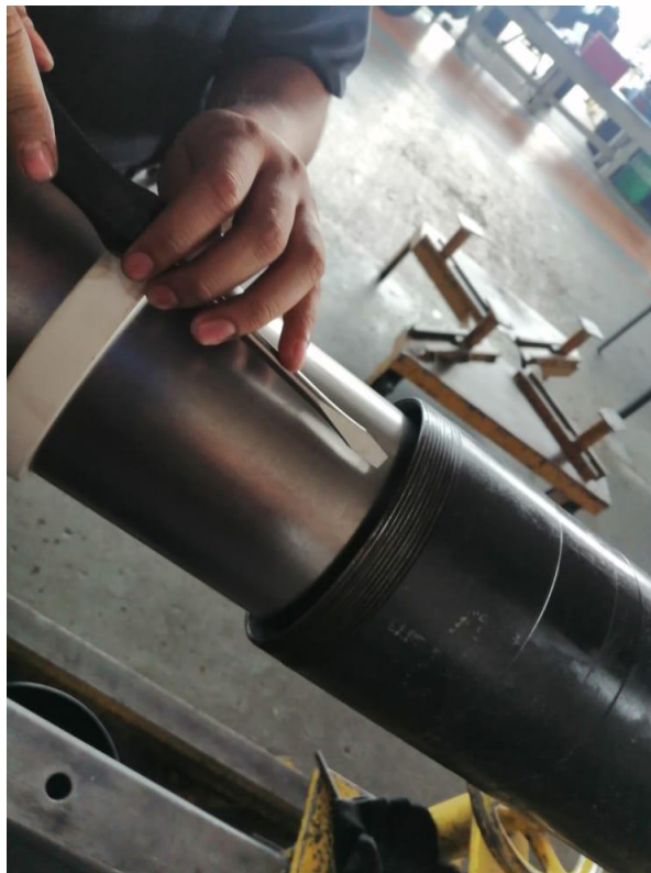
Ilustración 113: Desarmado y quitado de sellos de cilindro hidráulico de volqueta
