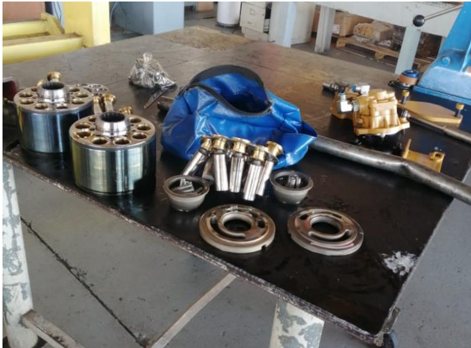
Ilustración 82: Elementos internos de la bomba hidráulica de pistones
