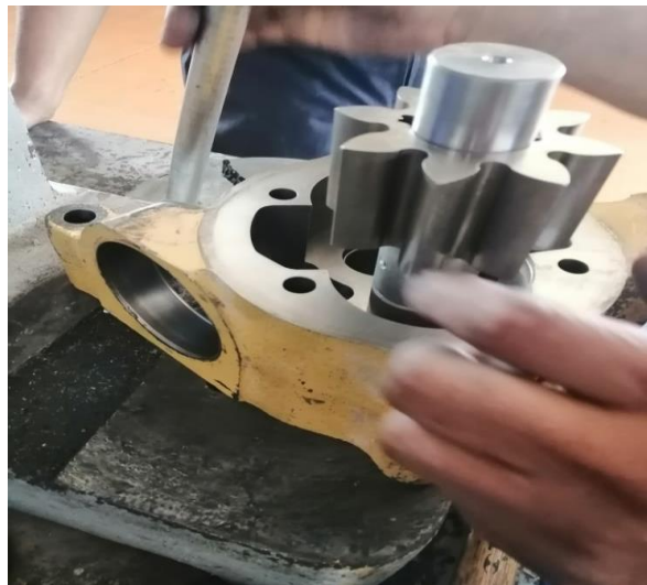
Ilustración 90: Proceso de desarmado de bomba de engranes
