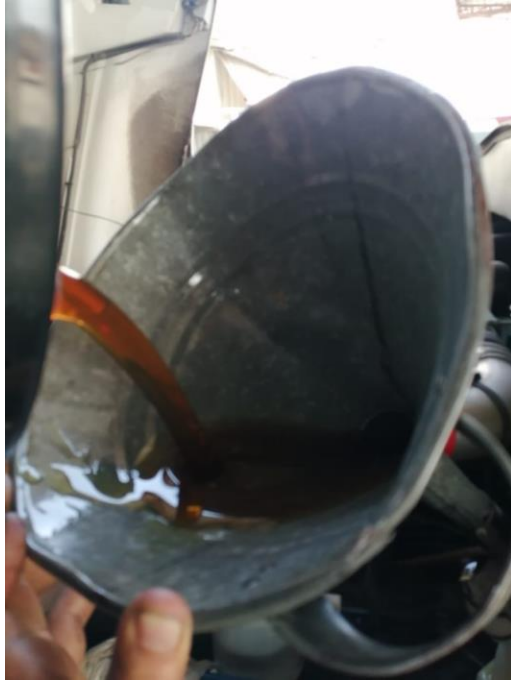
Ilustración 96: Cambio de aceite Mobil 15W-40
