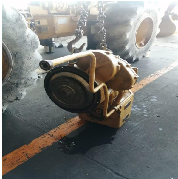
Ilustración 27: Desacople de transmisión del chasis del Skidder 525
