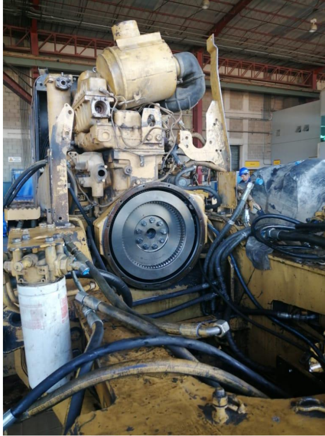
Ilustración 28: Skidder 525 con transmisión desacoplada
