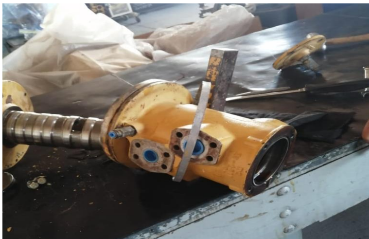
Ilustración 44: Desarmado de junta giratoria central
