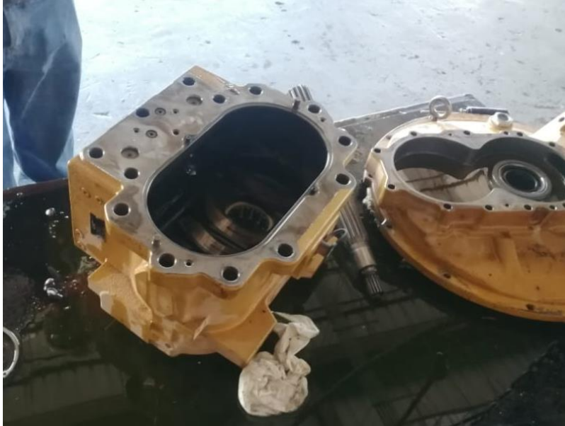
Ilustración 77: Desarmado de bomba hidráulica de pistones
