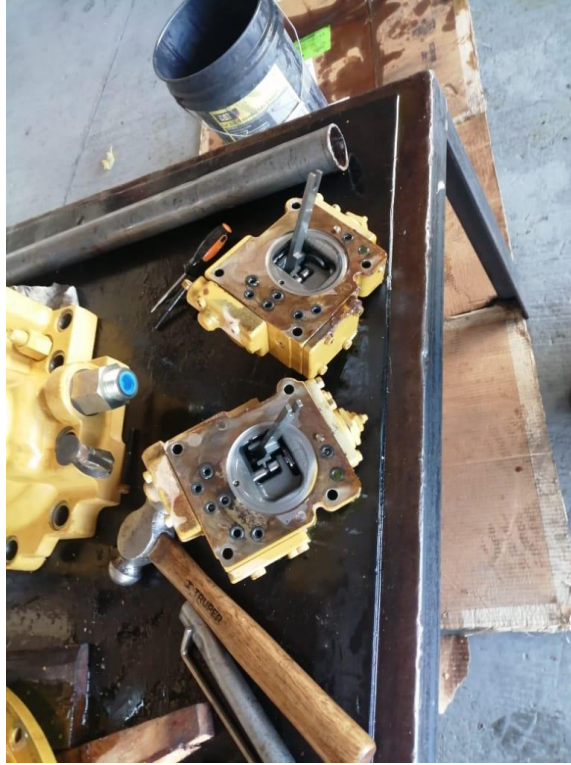
Ilustración 80: Actuadores responsables de la inclinación de los tambores de pistones
