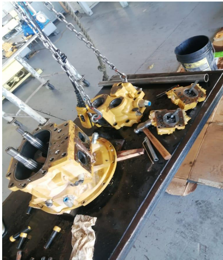
Ilustración 78: Desarmado de bomba hidráulica de pistones
