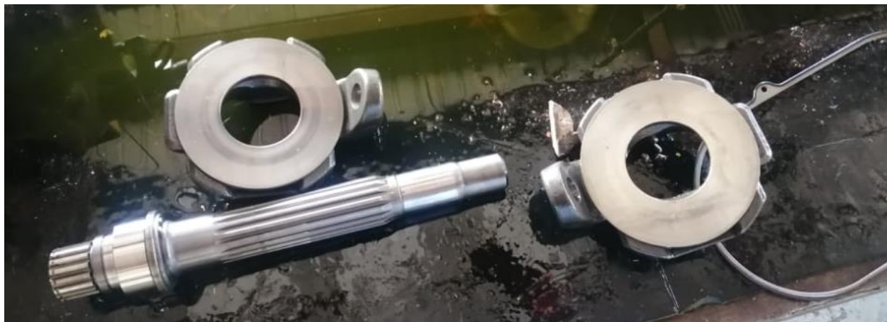
Ilustración 83: Platos de inclinación para tambores y eje giratorio de tambor
