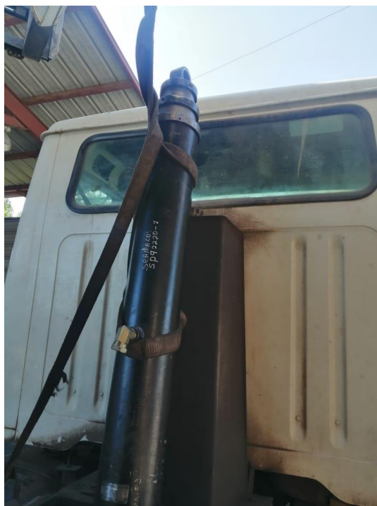
Ilustración 110: Desacople de cilindro hidráulico con eslinga de elevación de la volqueta
