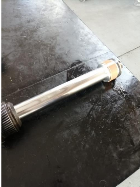
Ilustración 62: Desarmado de cilindro hidráulico dañado
