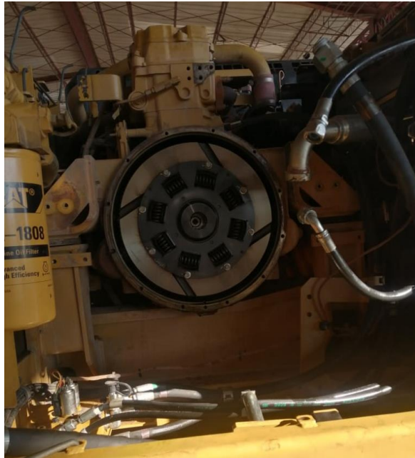
Ilustración 73: Desacople de bomba hidráulica de pistones
