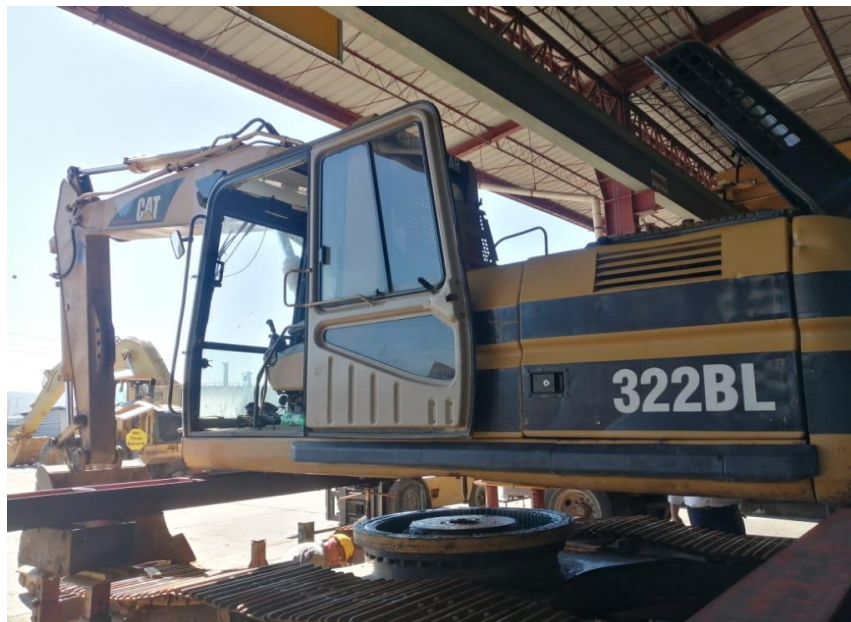
Ilustración 39: Desacople del chasis con estructura de orugas
