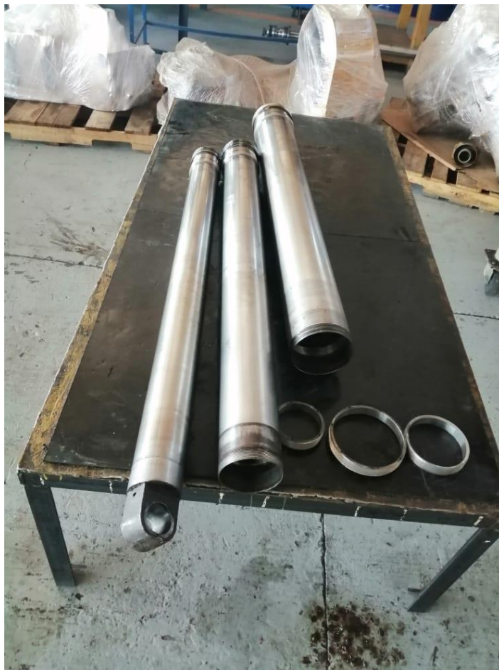
Ilustración 114: Desarmado total de cilindro hidráulico de volqueta
