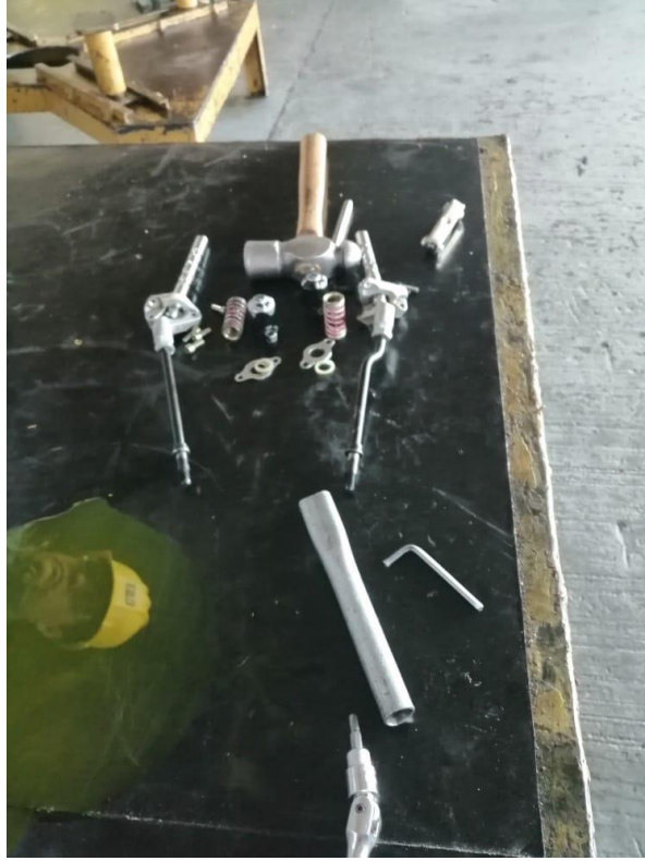
Ilustración 107: Desarmado de Válvula Hidráulica
