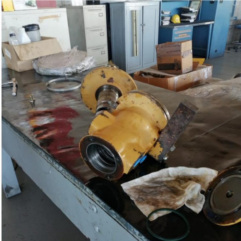
Ilustración 45: Desarmado total de junta giratoria central
