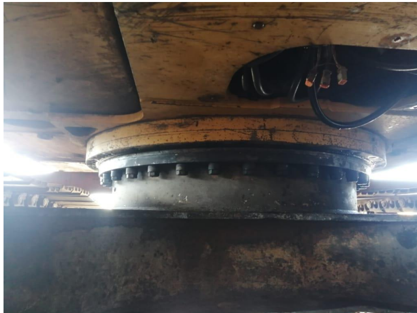
Ilustración 49: Acople de chasis con cuerpo de orugas con sus respectivos pernos
