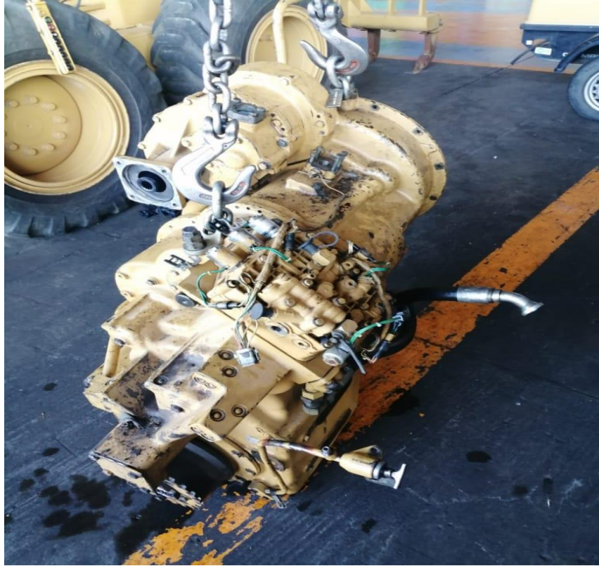
Ilustración 26: Desacople de transmisión del chasis del Skidder 525
