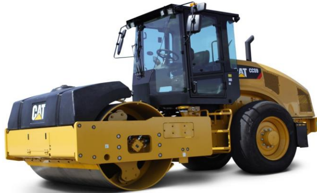
Ilustración 7: Compactador de asfalto de 130 hp de potencia
