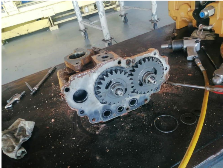
Ilustración 89: Proceso de desarmado de bomba de engranes
