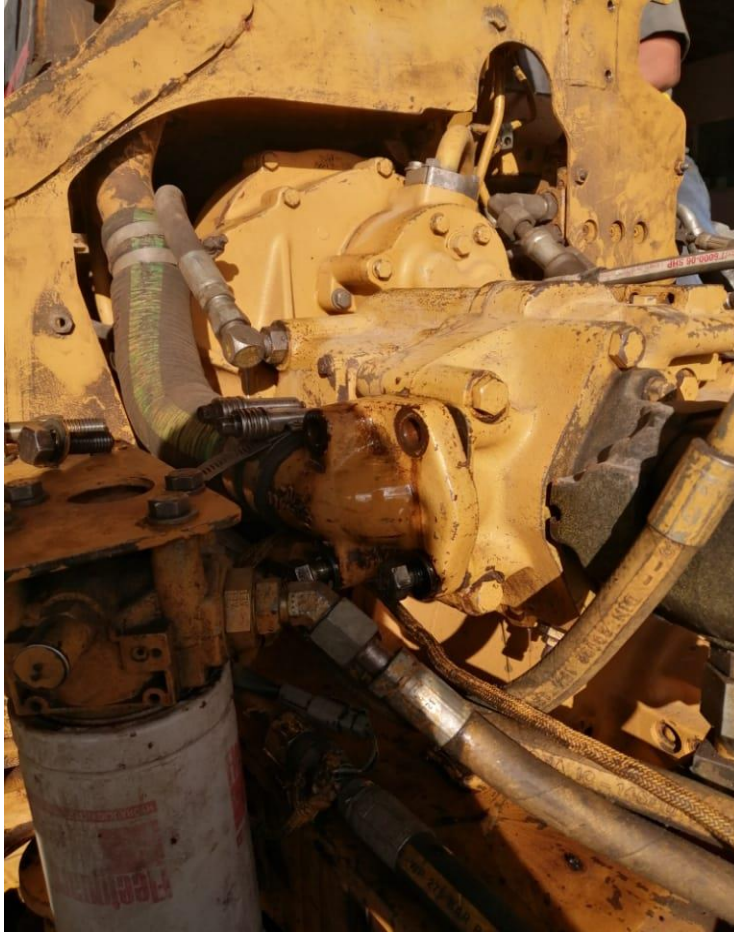
Ilustración 25: Desacople de líneas hidráulicas de caja de transmisión
