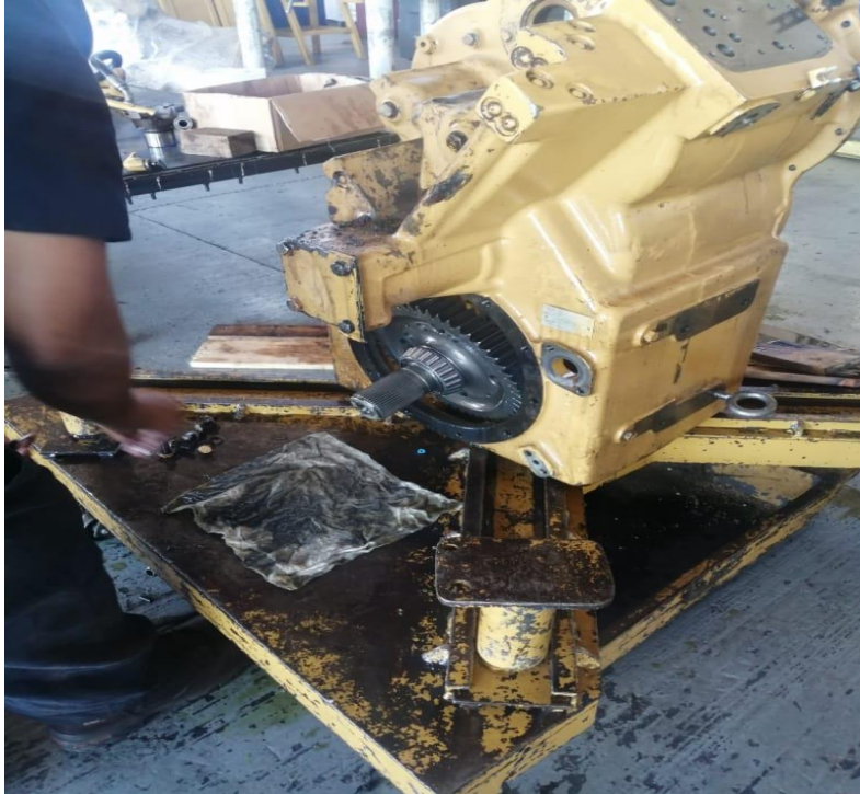
Ilustración 29: Proceso de desarmado de transmisión
