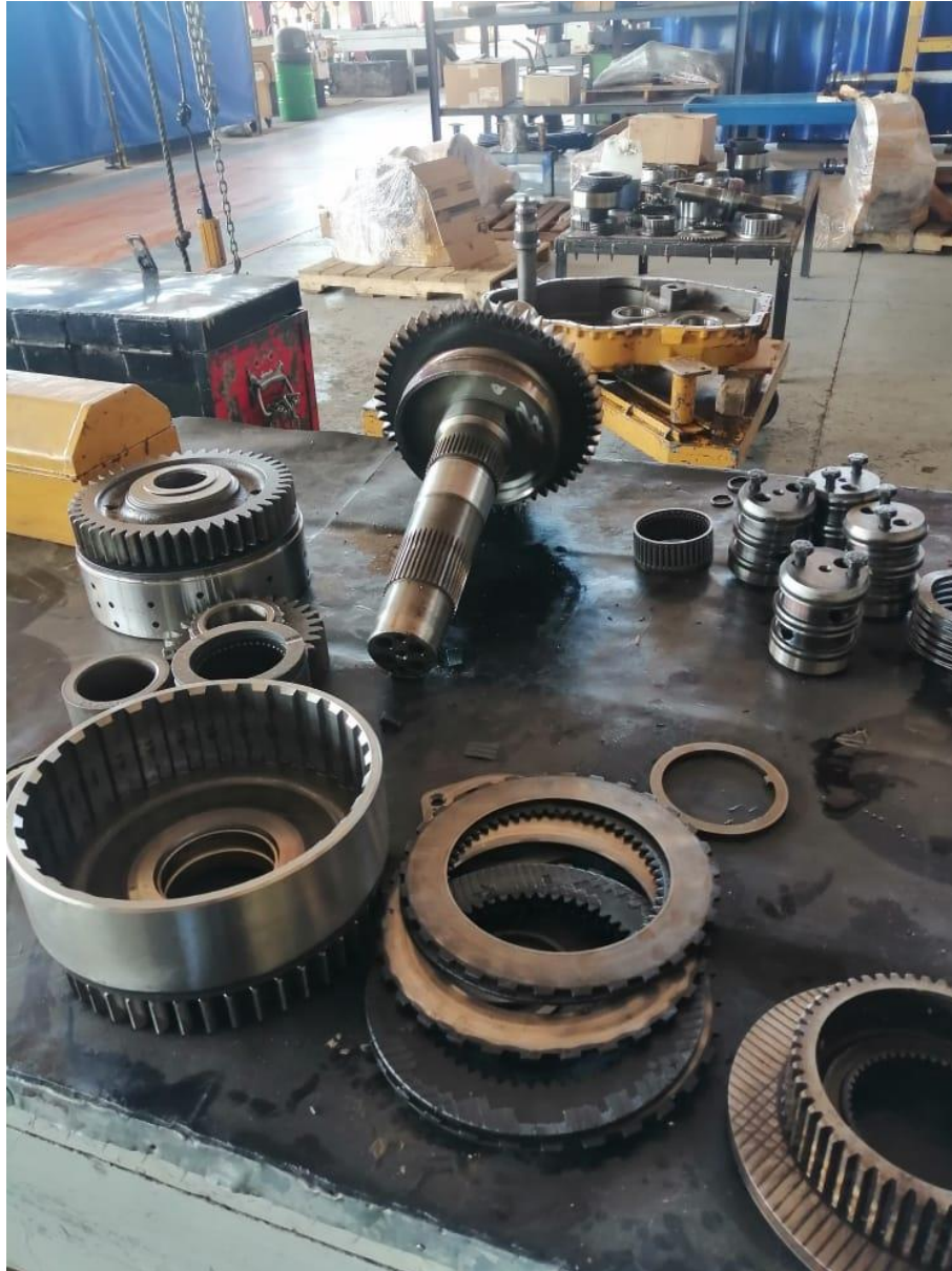
Ilustración 34: Eje central desarticulado con cámara de embragues dañada
