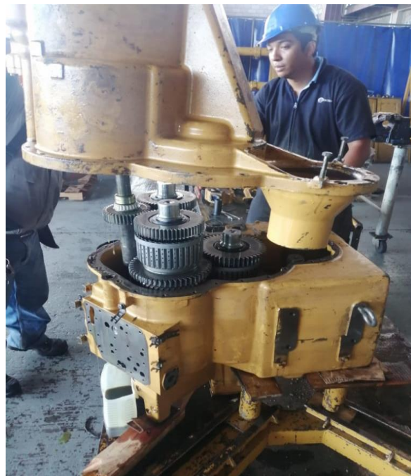
Ilustración 30: Proceso de desarmado de transmisión
