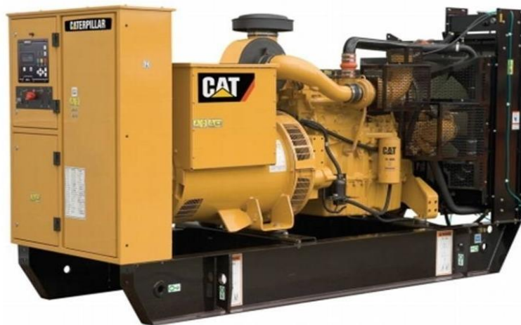
Ilustración 9: Generador eléctrico C9-272
