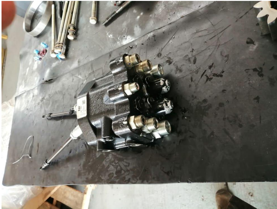
Ilustración 106: Válvula distribuidora de aceite hidráulico para caja de transmisión de un tractor New Holland
