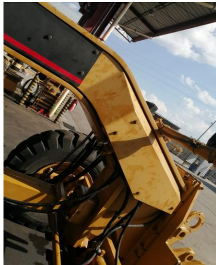
Ilustración 56: Desacople de guarda protectora de líneas hidráulicas
