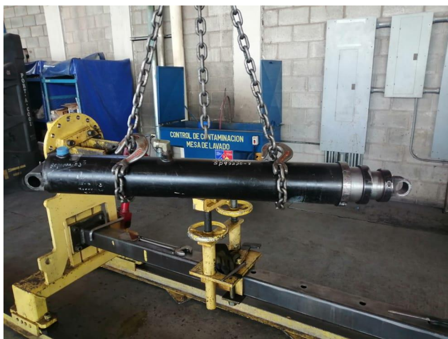
Ilustración 111: Posicionamiento para desarmado de cilindro hidráulico con tacle eléctrico y cadenas
