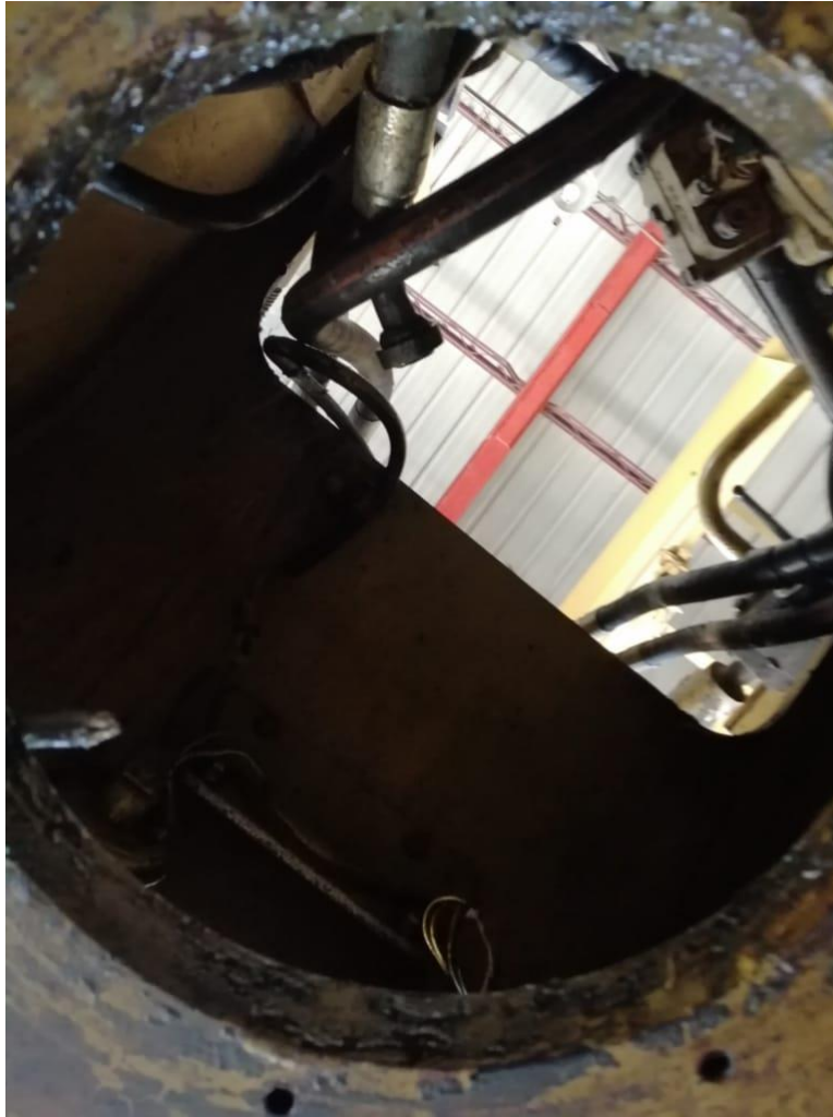
Ilustración 42: parte inferior del desacople de la junta giratoria central
