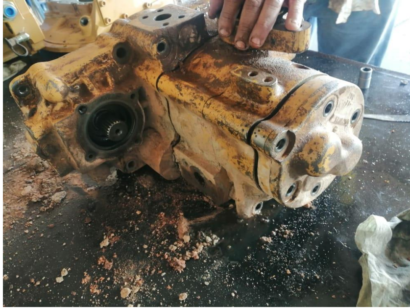
Ilustración 87: Bomba de engranes de cargador de cadena D6r
