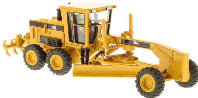
Ilustración 8: Motoniveladora 140H con 250 hp de potencia
