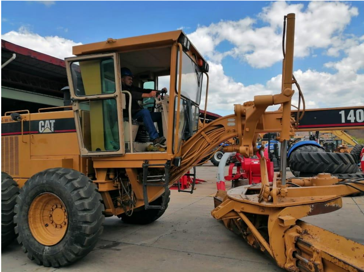
Ilustración 67: Motoniveladora 140H con operación normal luego de reparaciones
