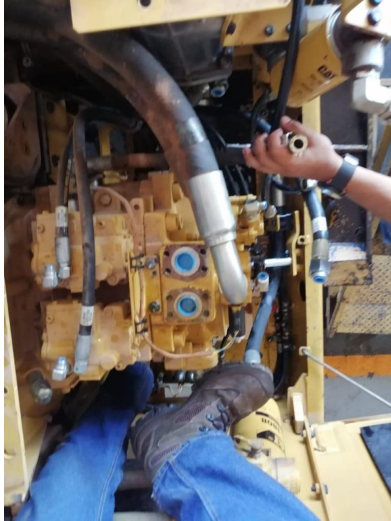
Ilustración 71: Desacople de líneas hidráulicas de bomba de pistones
