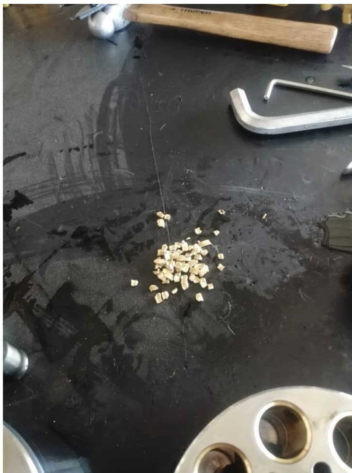
Ilustración 85: Residuos de metal por parte de cámara de pistón fracturada
