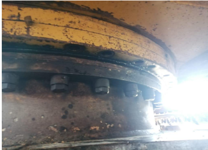
Ilustración 48: Acople de chasis con cuerpo de orugas con sus respectivos pernos
