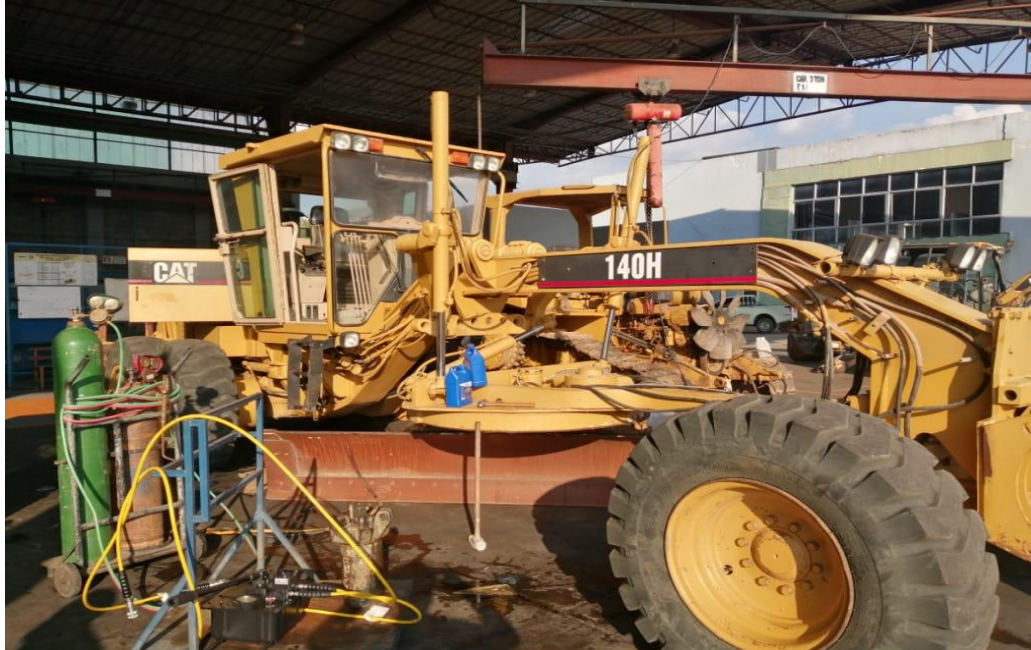
Ilustración 53: Motoniveladora con cilindros de oxígeno y nitrógeno para aplicación de calor al cilindro oxidado
