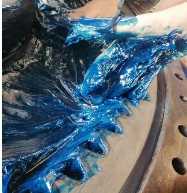
Ilustración 46: Colocación de grasa de cojinete bolas Caterpillar en el giro de tornamesa
