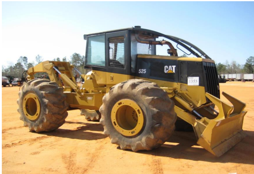
Ilustración 6: Skidder 525 con 130 hp de potencia
