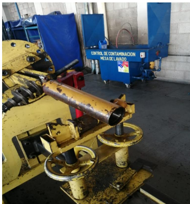
Ilustración 60: Desarmado de cilindro hidráulico dañado
