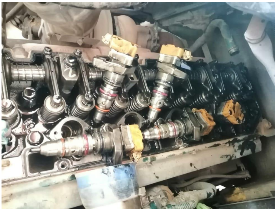
Ilustración 103: Desacople de inyectores de culata de motor DT466
