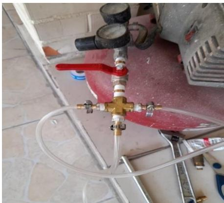
*Ilustración 22 Circuito Neumático*
