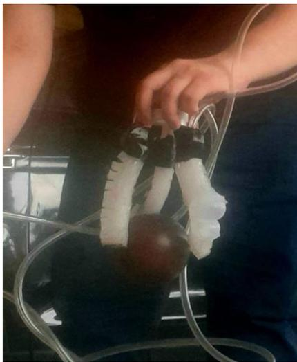
*Ilustración 25 Efector final sujetando una esfera*
