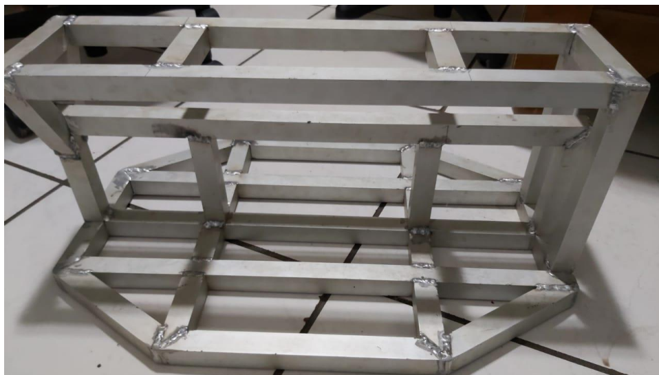
Ilustración 41-Fabricación del chasis
