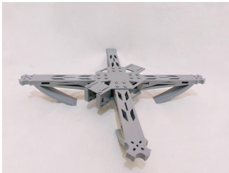
Ilustración 28 – Resultado sin Deformaciones de Prueba Física
