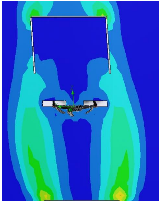
Ilustración 25 – Flujo de Aire y Creación de Vórtices alrededor del Modelo
