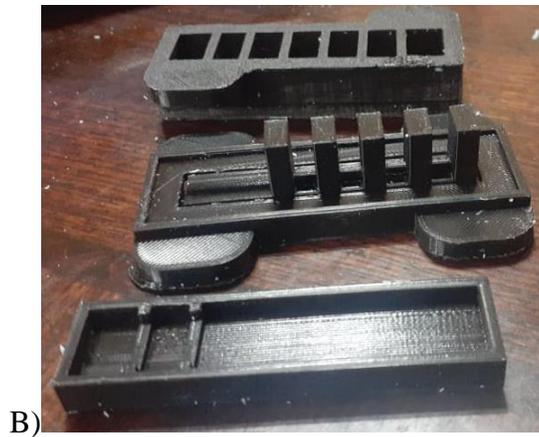
*Ilustración 10: Resultado de ensamble de moldes, B) Piezas de moldes por separado.*
