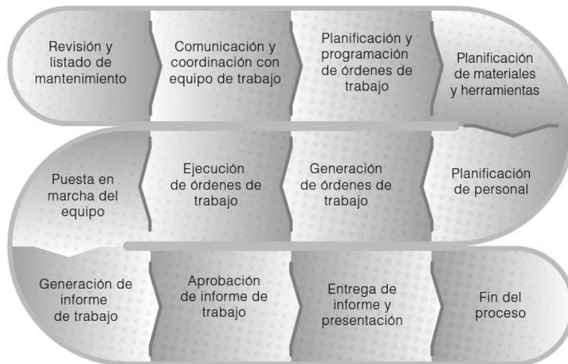
**Ilustración 21. Diagrama de los pasos para la ejecución del mantenimiento correctivo**
