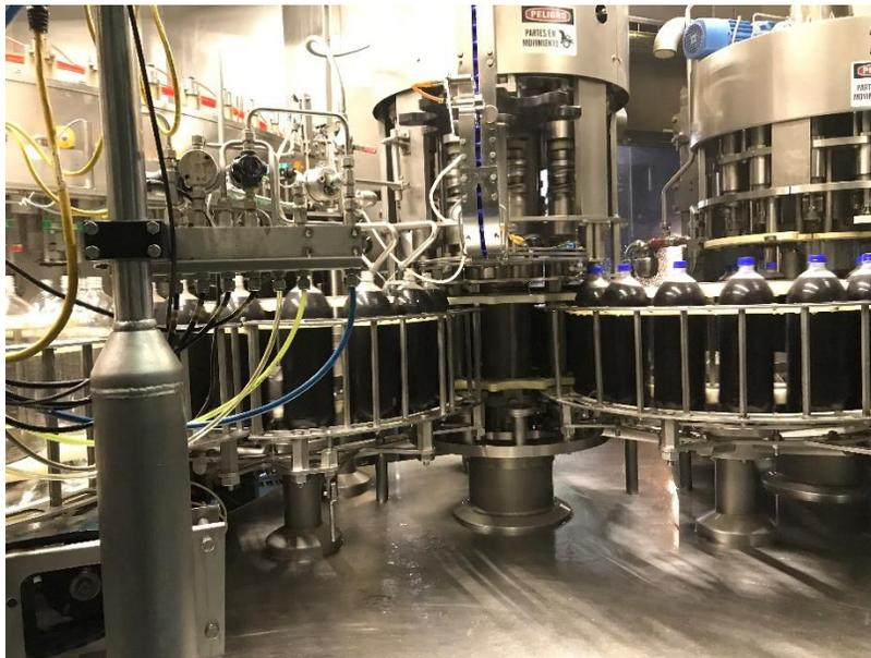
**Ilustración 7. Máquina de llenado y taponado de marca Krones**
