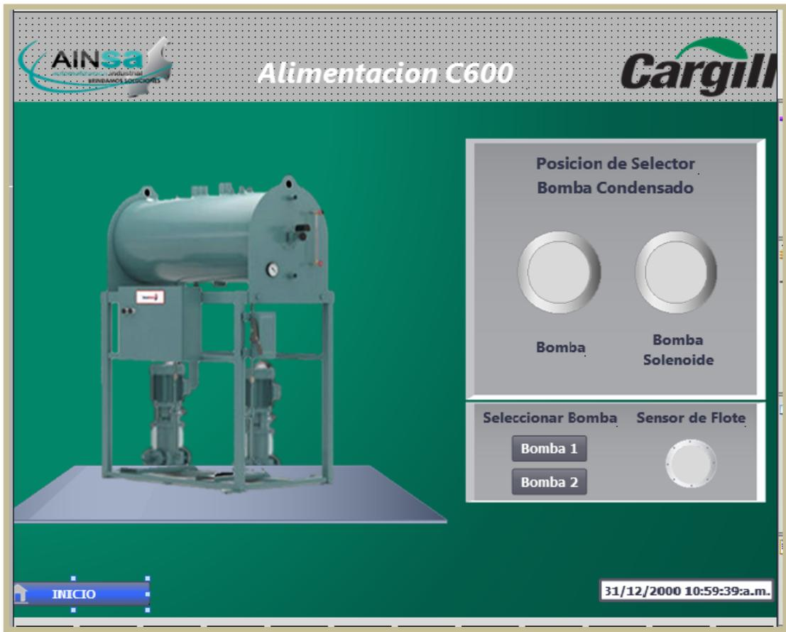
**ILUSTRACIÓN 24. PANTALLA DE SCADA, ALIMENTACIÓN CALDERA CB-600**
