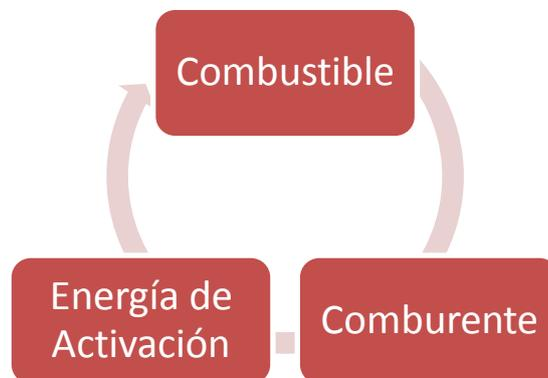
**ILUSTRACIÓN 4. TRIÁNGULO DE LA COMBUSTIÓN**
