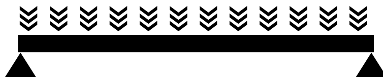
Ilustración 17- Viga apoyada en dos puntos
